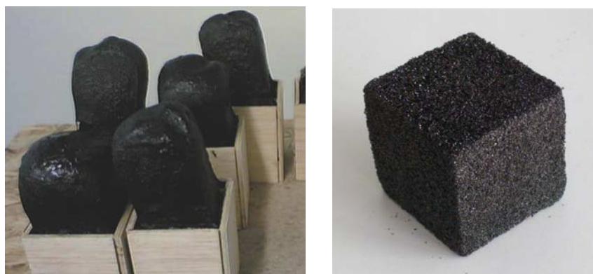
Figure 22 Des photos numériques des mousses rigides à base de tannin
