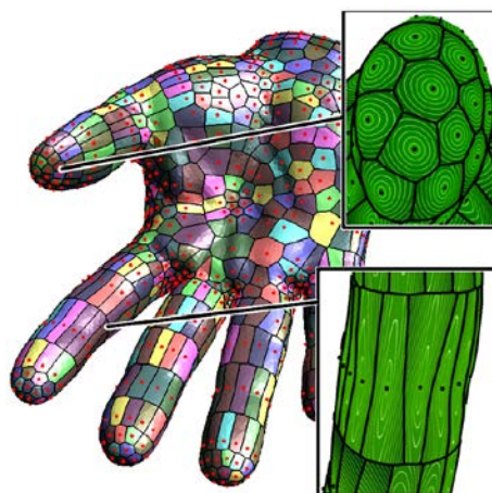
FIGURE 5.5 – Diagramme de Voronoï sur une surface 3D avec une anisotropie variable figurée par les ellipses concentriques au sein des cellules [LL10].
