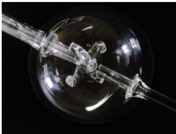
Figure 13: Le réacteur auto-agité par jets-gazeux
