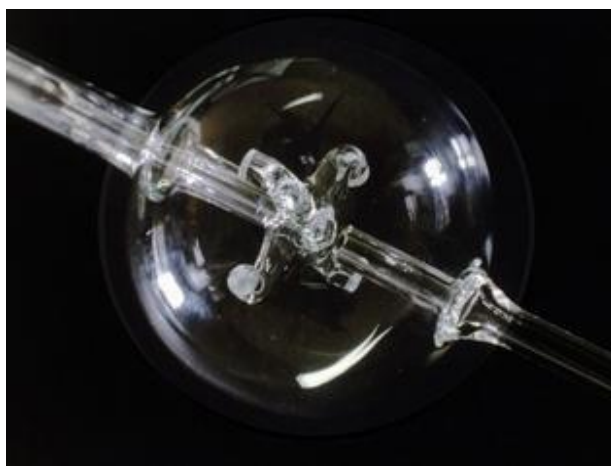
Figure 13: Le réacteur auto-agité par jets-gazeux
