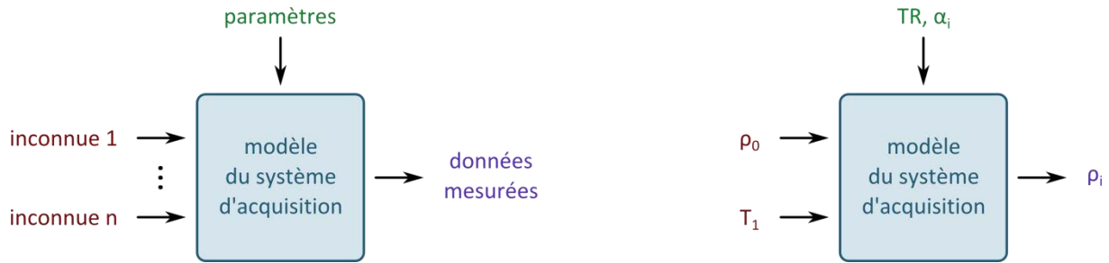
Figure 3.18 : Formalisation générale d'un problème de reconstruction (gauche) et application au cas du problème de quantification T_1 (droite).
