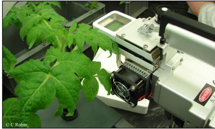
Figure 36: Mesures d'échanges gazeux sur une foliole à l'aide de la chambre de l'appareil Li-Cor 6400. Le dispositif d'éclairage n'est pas installé sur la pince lors de la prise de vue.
