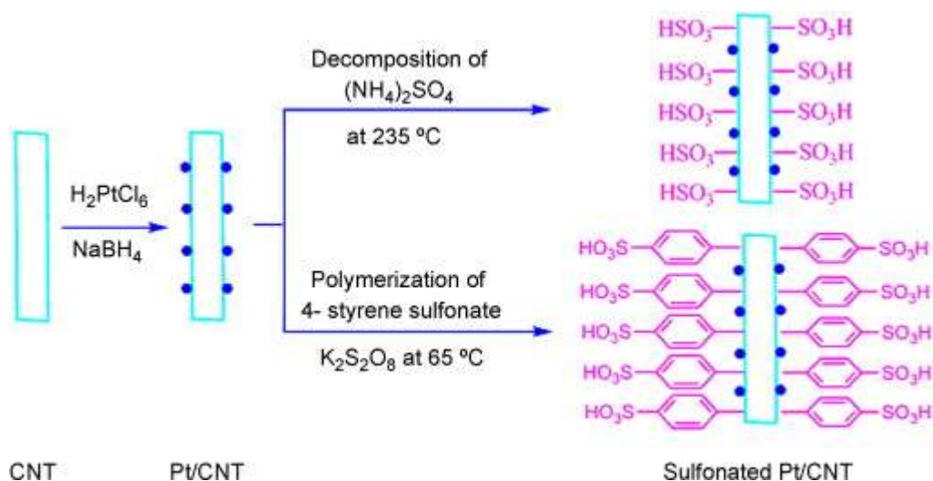
Figure I-27 : Schéma du dépôt de platine sur des nanotubes de carbone et de deux procédés de sulfonation : (a) par décomposition du sulfate d'ammonium et (b) par polymérisation radicalaire in situ du styrène sulfoné (138)
