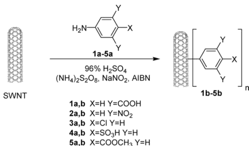
Figure I-26 : Fonctionnalisation des nanotubes de carbone monoparois par les dérivés de l'aniline dans l'acide de Caro (137)
