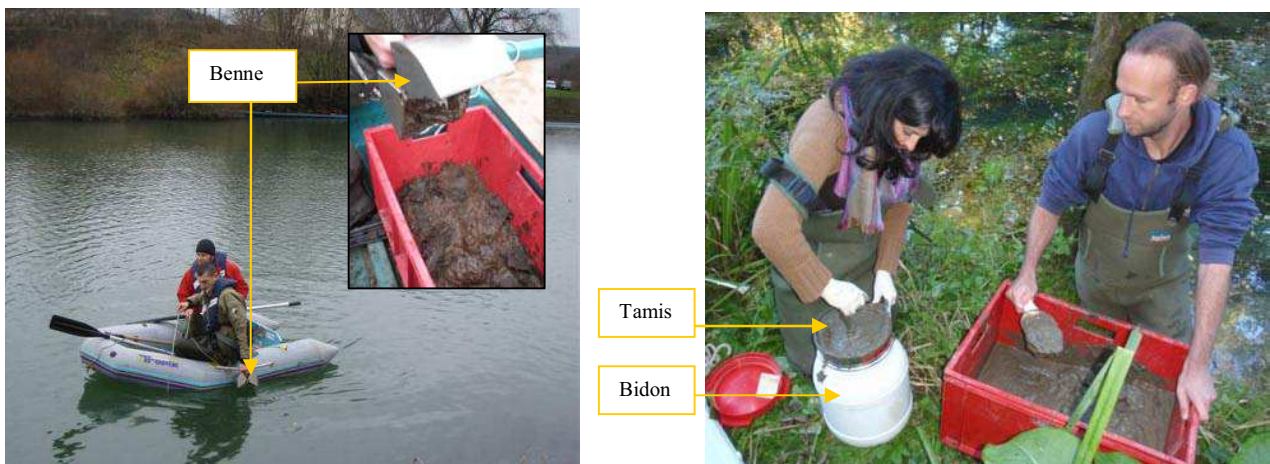
Figure II-1 : Prélèvement de sédiment à la benne et tamisage (Photos : source C. Durand)
