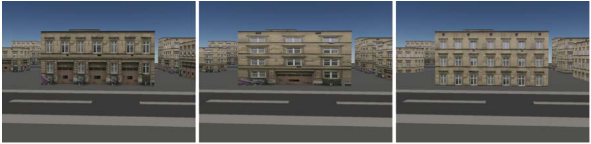
FIGURE E.1 – Trois méthodes différentes utilisées pour adapter les textures à leurs surfaces. Gauche : Synthèse de texture. Milieu : Etirement de texture. Droite : Découpage de textures.
