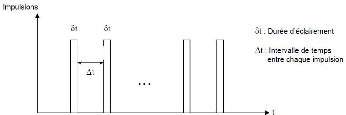
Figure II.9 – Schéma de fonctionnement d'un laser à impulsions
