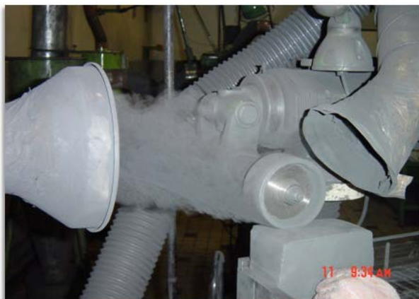
Figure I.1 – Opération de meulage
