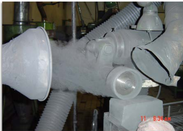
Figure I.1 – Opération de meulage
