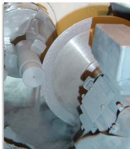
Figure I.2 – Opération de tronçonnage
