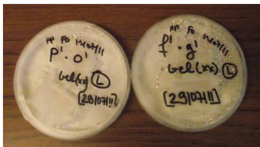
Figure 32 : Aspect des éprouvettes traitées avec le gel (issu du GlycérolC 14 ), lessivées, à la fin des 16 semaines d'exposition au Poria Placenta cultivé en boîte de pétri
