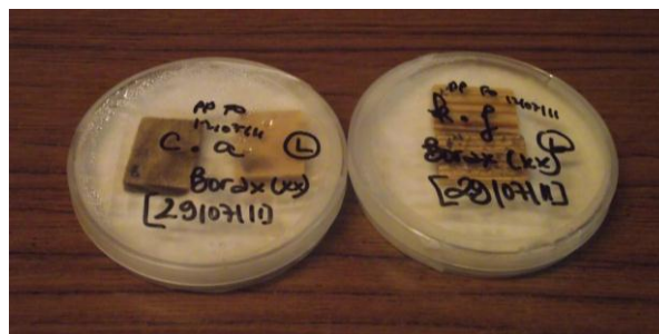
Figure 30 : Aspect des éprouvettes traitées au borax, lessivées, à la fin des 16 semaines d'exposition au Poria Placenta cultivé en boîte de pétri
