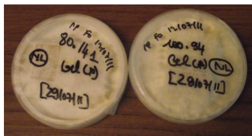
Figure 24 : Aspect des éprouvettes traitées au borax, non lessivées, à la fin des 16 semaines d'exposition au Poria Placenta cultivé en boîte de pétri
