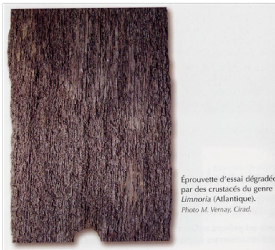
Figure 8 : Eprouvette d'essai dégradée par des crustacés du genre Limnoria (Atlantique)
