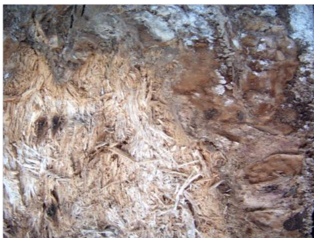
Figure 14 : Pourriture blanche provoquée par le Coriolus versicolor
