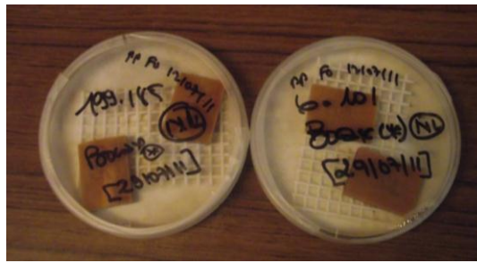
Figure 22 : Aspect des éprouvettes traitées au borax, non lessivées, à la fin des 16 semaines d'exposition au Poria Placenta cultivé en boîte de pétri
