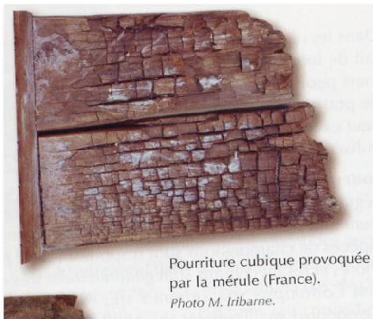
Figure 13 : Pourriture cubique provoquée par la mérule (France)
