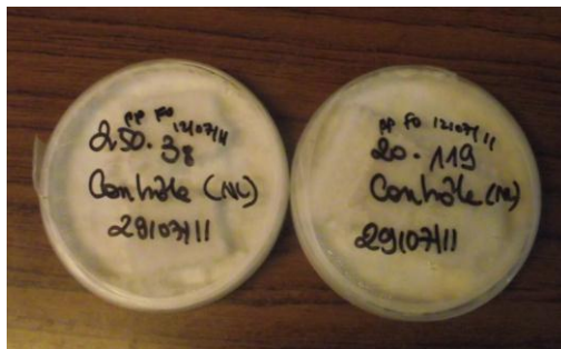
Figure 29 : Aspect des éprouvettes témoins à la fin des 16 semaines d'exposition au Poria Placenta cultivé en boîte de pétri
