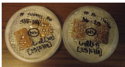
Figure 32 : Aspect des éprouvettes traitées au gel (GlycérolC 14 ), non lessivées, à la fin des 16 semaines d'exposition au Poria Placenta cultivé en boîte de pétri
