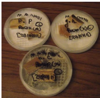
Figure 21 : Aspect des éprouvettes traitées au borax, lessivées, à la fin des 16 semaines d'exposition au Poria Placenta cultivé en boîte de pétri
