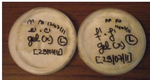
Figure 23 : Aspect des éprouvettes traitées avec le gel, lessivées, à la fin des 16 semaines d'exposition au Poria Placenta cultivé en boîte de pétri
