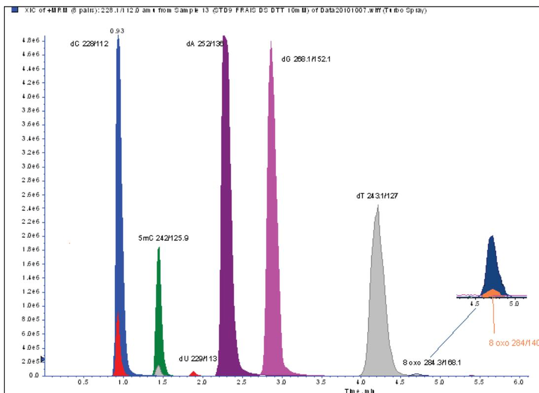
**Figure III.4.** Chromatogramme montrant le profil d'éluion des nucléosides
