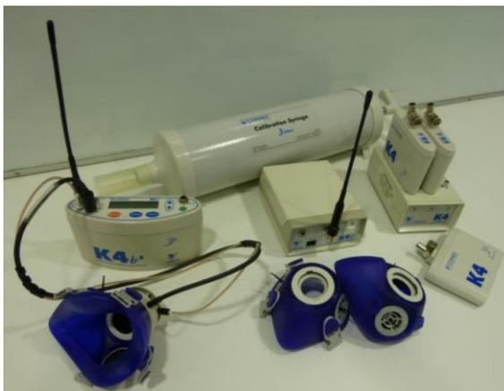
Figure 46. Système téléométrique Cosmed K4b<sup>2</sup>®.
