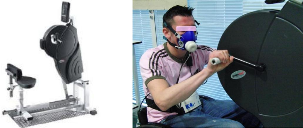
Figure 42. Test d'effort sous-maximal sur ergocycle à bras (Upper body cycle, Kardiomed<sup>®</sup>).
