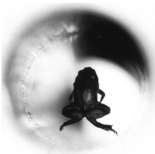
Figure 1.3 Grenouille en lévitation magnétique dans un solénoïde de 16 T d'après [36]
