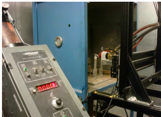
Figure 28 : Pistolet utilisé pour réaliser le revêtement par technique de projection thermique à chaud des implants en alliage de titane des groupes 2 & 3
