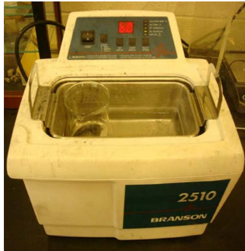
Figure 29 : Technique d'ultrasonication pour mélanger les poudres d'HA et de NTC
