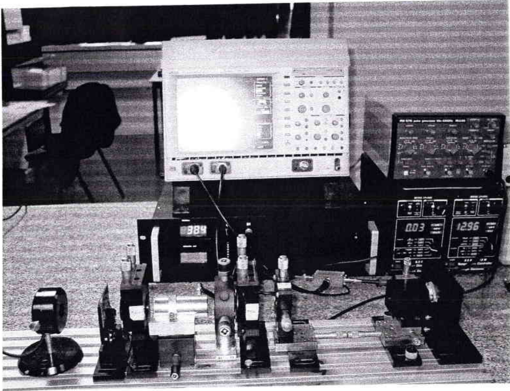
Figure 4. 8: Dispositif expérimental du laser YAG : Nd déclenché par une cellule de Pockels constituée par un cristal de \text{LiNbO}_3 .
