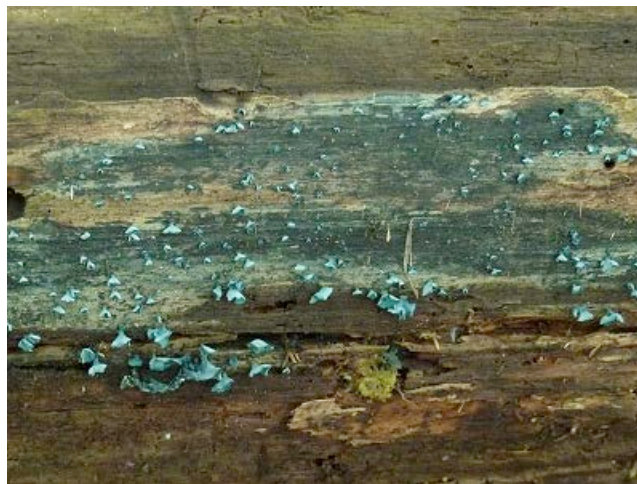
Figure 20 : Coloration de la surface du bois due à la présence d'agents de bleuissement ( http://www.wiseacre-gardens.com/ ).
