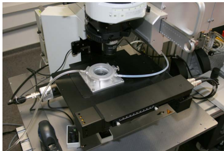
Fig. II.5: Cellule d'ablation et série de diaphragmes permettant de choisir le diamètre du cratère d'ablation entre 5 \mu\text{m} et 160 \mu\text{m} .
