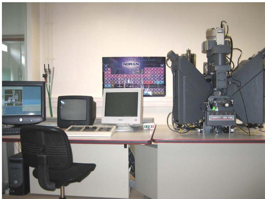
FIGURE 3.5 – Microsonde électronique Cameca SX100
