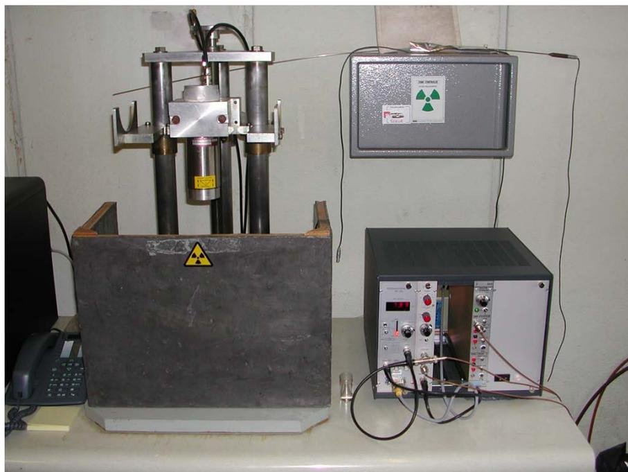
FIGURE 3.14 – Spectromètre Mössbauer
