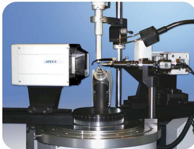
FIGURE 3.3 – Diffractomètre 3 cercles Apex II à détecteur CCD
