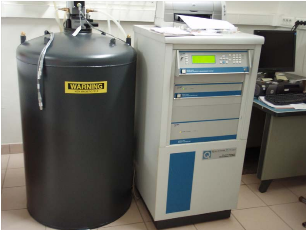
FIGURE 3.6 – PPMS-9T (Service Commun de Magnétisme, UHP Nancy)
