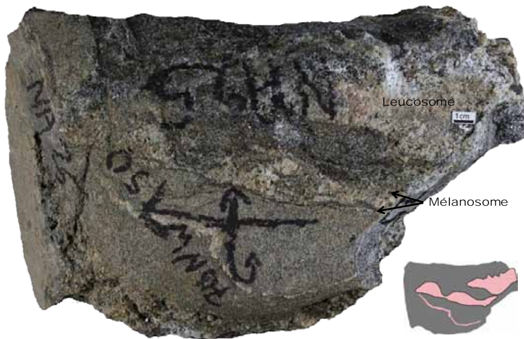
Figure III.26 : Métatexite caractérisée par des veines et poches leucosome bordées de mélanosome dont la texture grenue et la composition dominée par le quartz sont interprétées comme reflétant une origine métasédimentaire. Echantillon 9544-25A.
