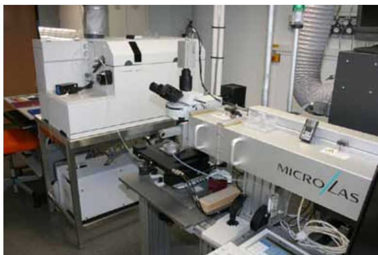
Fig. 1 Ablation laser ICP-MS installé dans l'UMR G2R. On distingue le laser d'ablation (MicroLas) le microscope permettant de focaliser le laser et de contrôler le diamètre d'ablation. L'ICP-MS (série 7500, Agilent) est situé au dernier plan.
