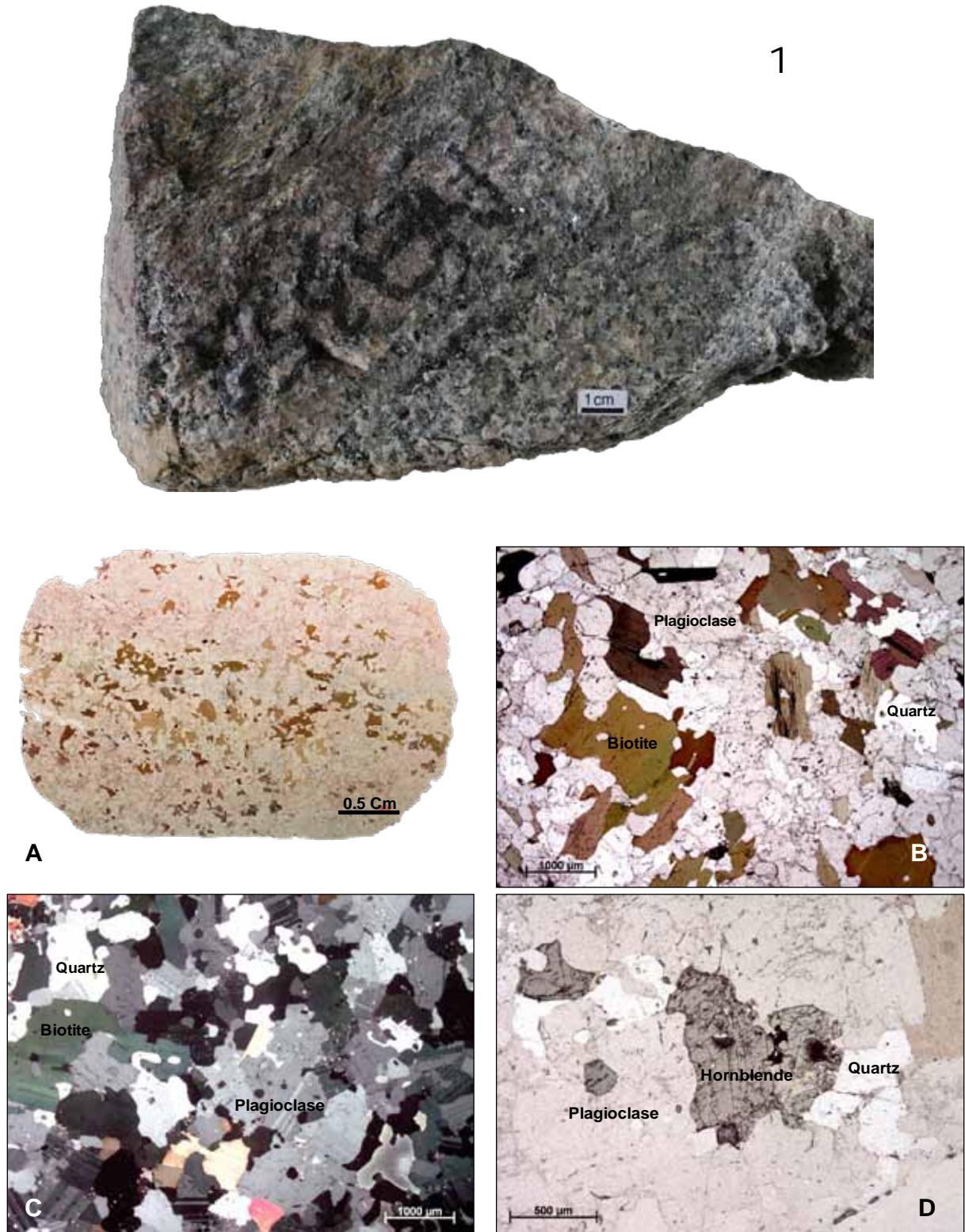
Figure III.22 : 1. Echantillon macroscopique de diatexite avec foliation symmigmatitique soulignée par l'orientation d'agrégats de biotite. Complexe gneissique d'Abbabis. Echantillon 9544-35A, Stop 35. A. Lame mince avec orientation préférentielle de biotite au centre. B. Détail de biotites sub-automorphes. C. Plagioclases et quartz en remplissage interstitiel ou en exsolution. Aspect lobé des minéraux. D. Détail d'une hornblende verte, faciès amphibolite.
