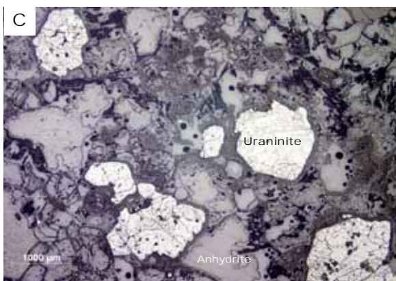
Figure V.85 : 1. Echantillon de skarn minéralisé en Uranium dans un sondage du prospect d'Inca (DYL). A & A' fraction granitique à quartz et feldspaths (respectivement LN et LPA). B & B' Zone de transition à amphiboles et oxydes de fer et ilménite. Zone minéralisée à méganodules uraninite et anhydrite.
