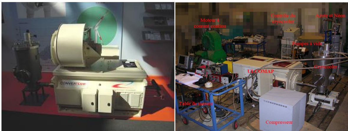
Figure I-22: gauche : machine 250 KW -1500 tr/min, droite : la machine sur le banc d'essai, Converteam Nancy
