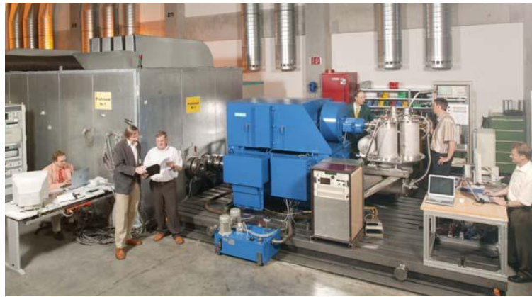
Figure I-20 : Générateur 4 MVA – 3600 tr/min sur le banc d'essai, Siemens
