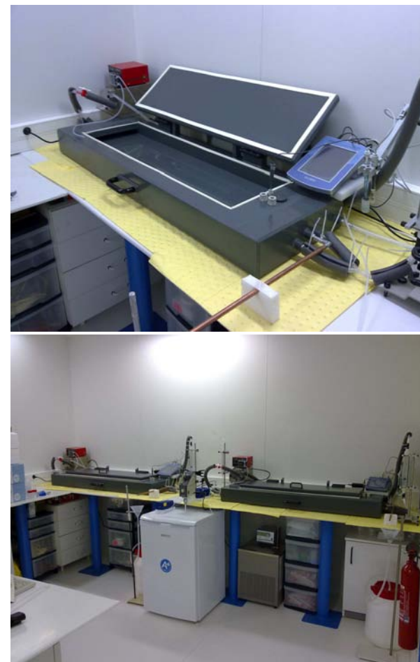
Figure 15 : Schéma du système expérimental avec (1) réacteur en polychlorure de vinyle (2) bain thermostaté (3) pompe d'alimentation en eau (4) bac d'alimentation en eau (5) pompe de recirculation (6) boîtier multiparamètres et sondes (pH, conductivité, température, oxygène dissous) (7) bac de purge.
