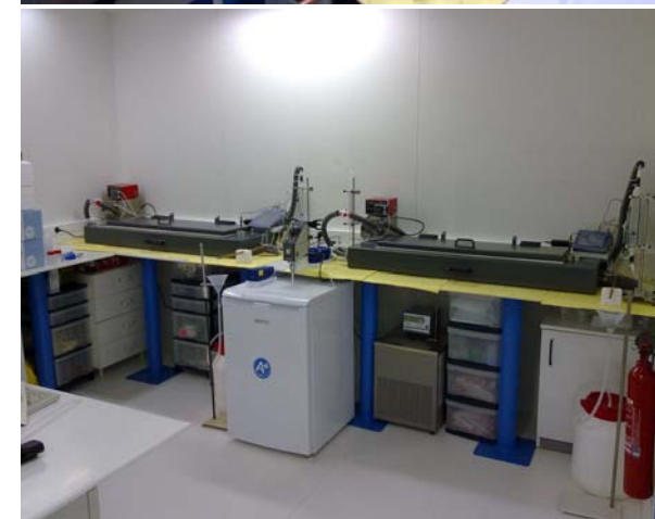
Figure 15 : Schéma du système expérimental avec (1) réacteur en polychlorure de vinyle (2) bain thermostaté (3) pompe d'alimentation en eau (4) bac d'alimentation en eau (5) pompe de recirculation (6) boîtier multiparamètres et sondes (pH, conductivité, température, oxygène dissous) (7) bac de purge.
