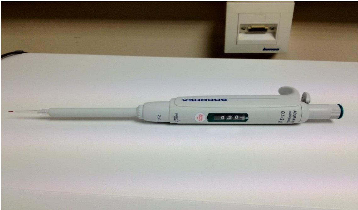
Figure IV-3 : La micropipette utilisée (Micropipette Socorex, Acura 825) pour déposer le volume fluide de 0.2 \mu l.
