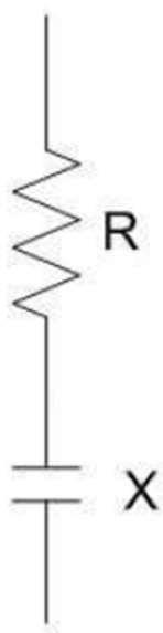
Figure I-11 : Une partie du circuit électrique composé d'une résistance R et d'une réactance X.
