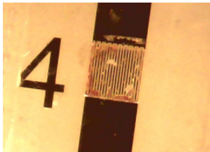
Figure IV-15 : Image du capteur 4 après le deuxième nettoyage.
