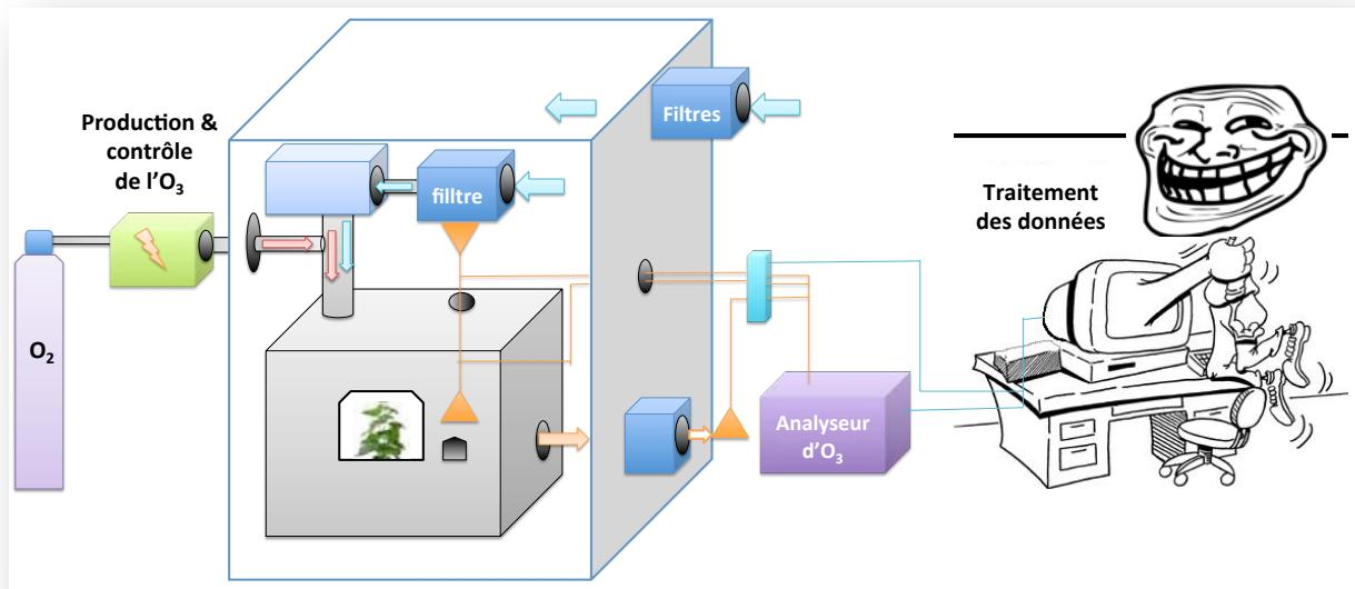
**Figure 24.** Représentation schématique du dispositif de fumigation.
