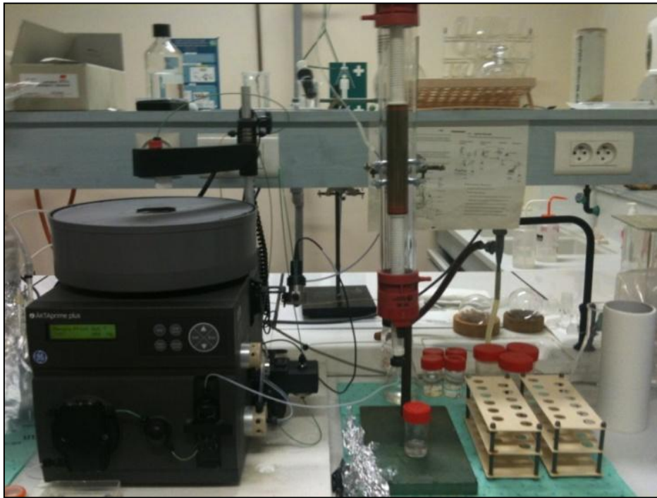
Figure 42 : Photo du montage de la colonne et du système Aktaprime
