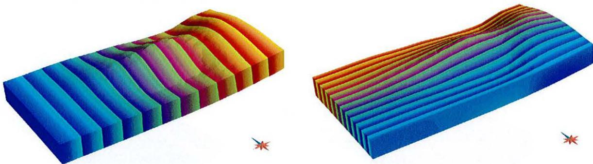
FIG. 3.17 : Paramétrisation  $(u, v)$  obtenue par la contrainte d'orthogonalité 3D (à gauche,  $u(\mathbf{x})$ , à droite  $v(\mathbf{x})$ ), exagération verticale  $\times 2$ . Les lignes de couleur représentent des lignes d'isovaleurs. Ces lignes sont équidistantes sur l'horizon de référence (figure 3.16).
