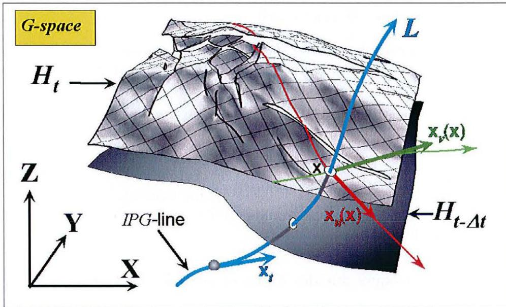
FIG. 2.9 : Intégration d'un horizon de référence et d'une ligne IPG dans la construction d'un modèle GeoChron. Quelle que soit la méthode de construction, les valeurs de  $t$  doivent être constantes sur chaque horizon et les valeurs de  $(u, v)$  doivent être constantes le long d'une ligne IPG ([Mallet, 2004]).
