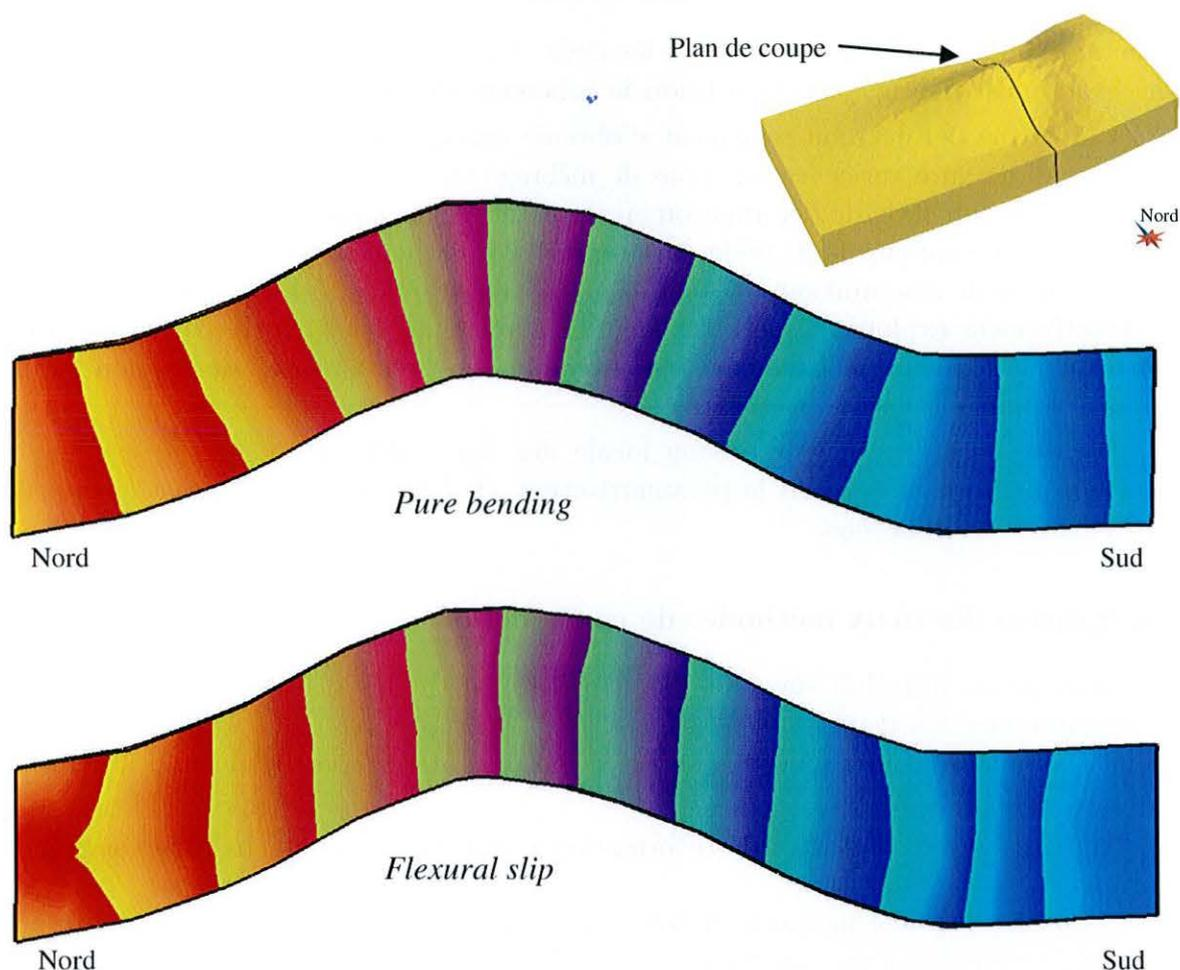
FIG. 3.20 : Comparaison en coupe (exagération verticale  $\times 2$ ) entre les deux contraintes de paramétrisation globale. En haut, la paramétrisation obtenue par orthogonalité 3D, en bas par conformal mapping étendu. Les lignes sont similaires à celles observées suivant les styles de déformation (figures 2.10 et 2.12).
