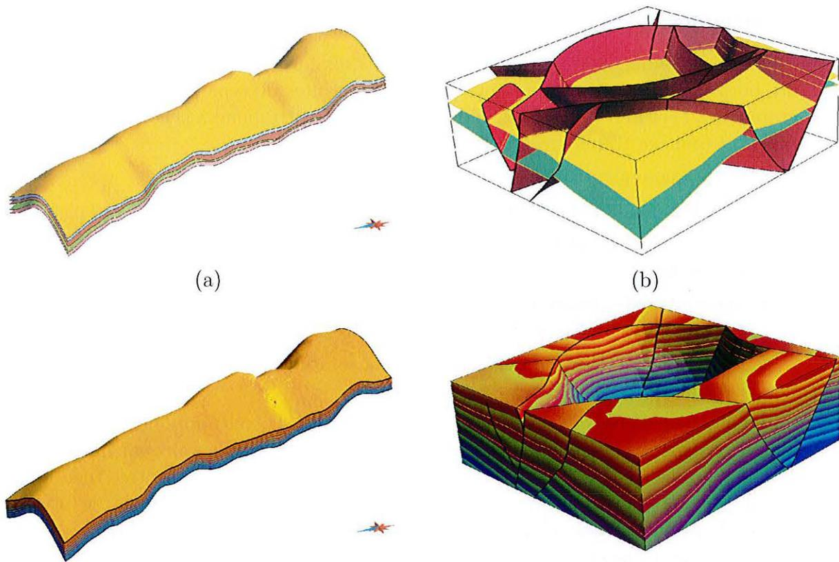
FIG. 3.1 : Exemples de construction de la composante  $t$  de la paramétrisation. En haut, le modèle surfacique, en bas, le temps calculé sur un volume tétraédrique. (a) : exemple non faillé (données Chevron). (b) : modèle faillé (données Total).
