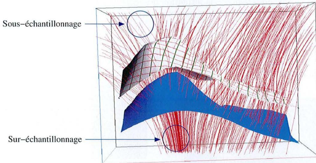
FIG. 3.8 : Champ de fibres extraites depuis un horizon de référence par la méthode de Runge-Kutta. Une paramétrisation par conformal mapping (représentée par les lignes d'isovaleur de  $u$  et  $v$  rouges et vertes) est calculée sur l'horizon de référence (en haut) et sera propagée dans le volume le long des fibres. La densité des fibres est très variable suivant la position dans le volume et dépend de la courbure de l'horizon de référence.
