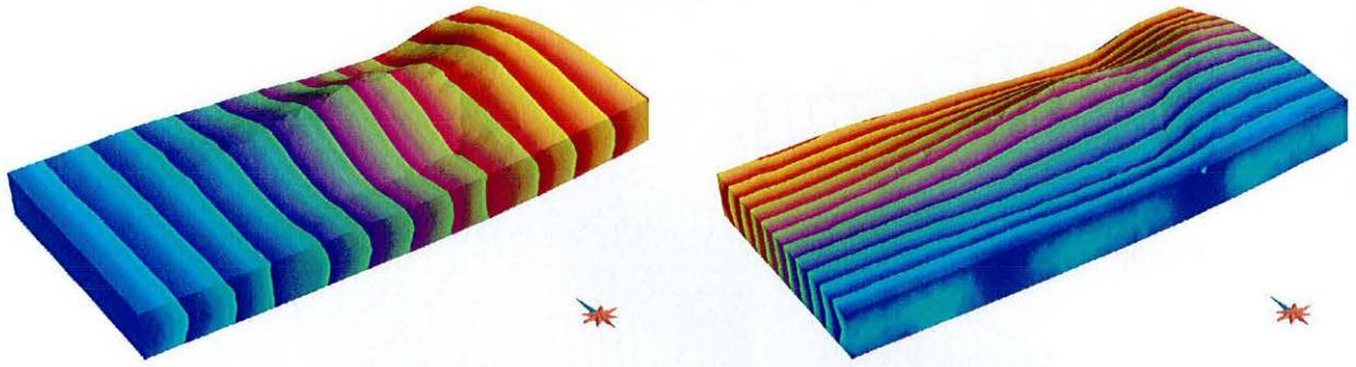
FIG. 3.18 : Paramétrisation  $(u, v)$  obtenue par la contrainte de conformal mapping étendu (à gauche,  $u(\mathbf{x})$ , à droite  $v(\mathbf{x})$ ), exagération verticale  $\times 2$ . Les lignes de couleur représentent des lignes d'isovaleurs. Ces lignes sont équidistantes sur l'horizon de référence (figure 3.16).
