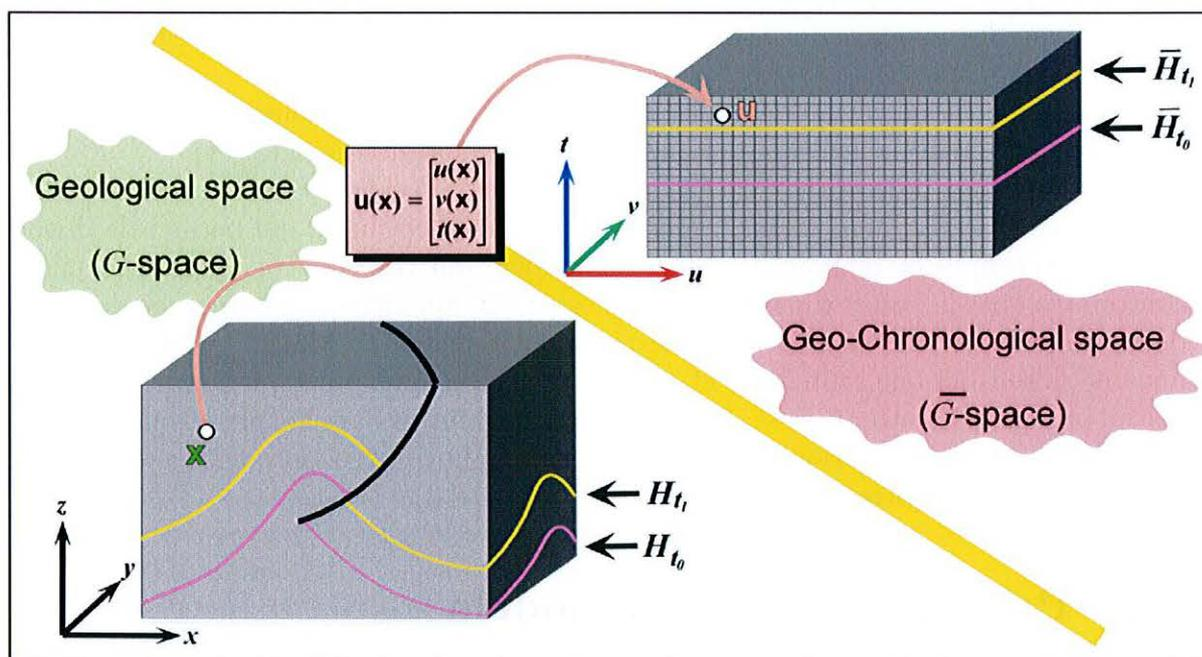
FIG. 2.1 : Schéma de principe de l'espace GeoChron. En bas, un modèle géologique  $G$ , avec des horizons  $H_{t_0}$  et  $H_{t_1}$  plissés et faillés. En haut, les images de ces horizons dans l'espace paramétrique  $\bar{G}$  sont des surfaces planes non faillées ([Mallet, 2004]).
