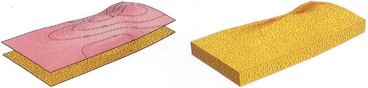
FIG. 3.14 : Modèle initial de l'anticlinal de Split Mountain, Utah (données IFP), exagération verticale  $\times 2$ . À gauche, les deux horizons triangulés reconstitués à partir des données de terrain, avec des courbes de niveau sur l'horizon supérieur et le maillage sur l'horizon inférieur. À droite, le volume tétraédrique correspondant.
