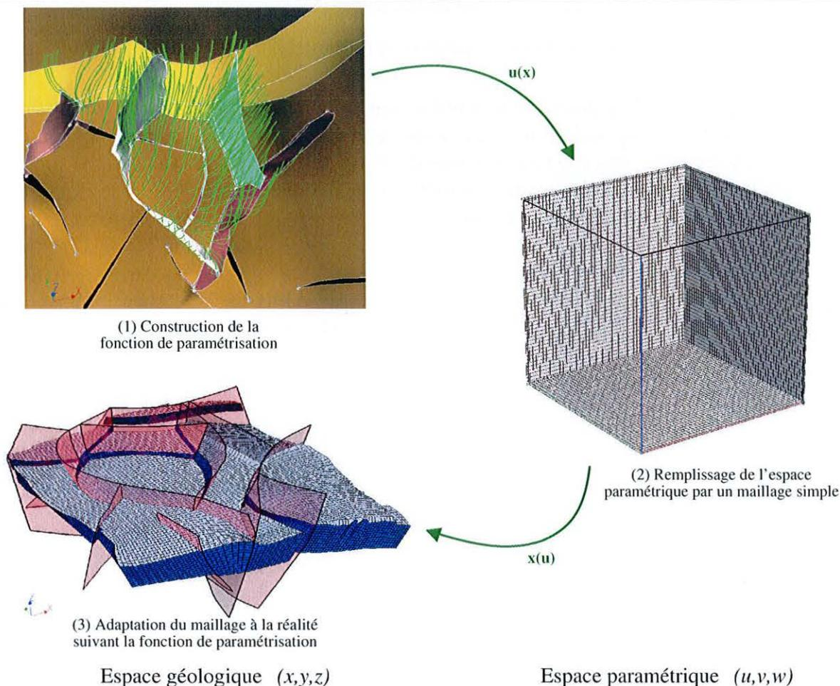
FIG. 1.13 : Principe général de construction d'une grille paramétrique. (1) Construction d'une fonction de paramétrisation  $\mathbf{u}(\mathbf{x})$  dans l'espace géologique : les lignes vertes représentent des lignes de coordonnée  $W$ , qui suivent les failles. (2) Construction d'un maillage régulier simple dans l'espace paramétrique. (3) Grâce à la fonction de paramétrisation ou à son inverse  $\mathbf{x}(\mathbf{u})$ , la grille paramétrique est déformée sur l'espace géologique.
