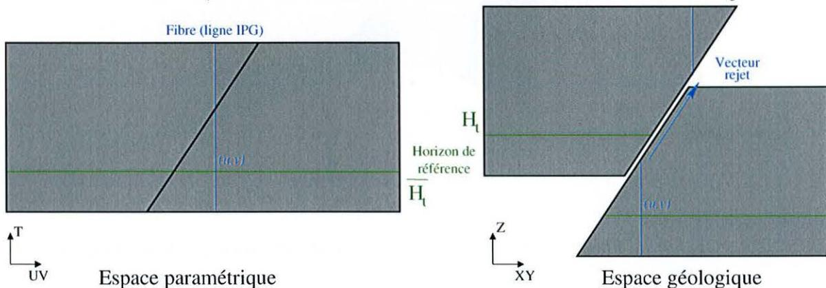
FIG. 3.9 : Principe de tracé des fibres au travers d'une faille. À gauche, une fibre (en bleu) extraite en un point  $(u, v)$  sur l'horizon de référence  $H_t$  ( $\bar{H}_t$ ) dans l'espace paramétrique, en vert) apparaît dans l'espace paramétrique comme une ligne verticale, car c'est une ligne IPG. Son image dans l'espace géologique (à droite) est quant à elle décalée suivant le rejet de la faille.
