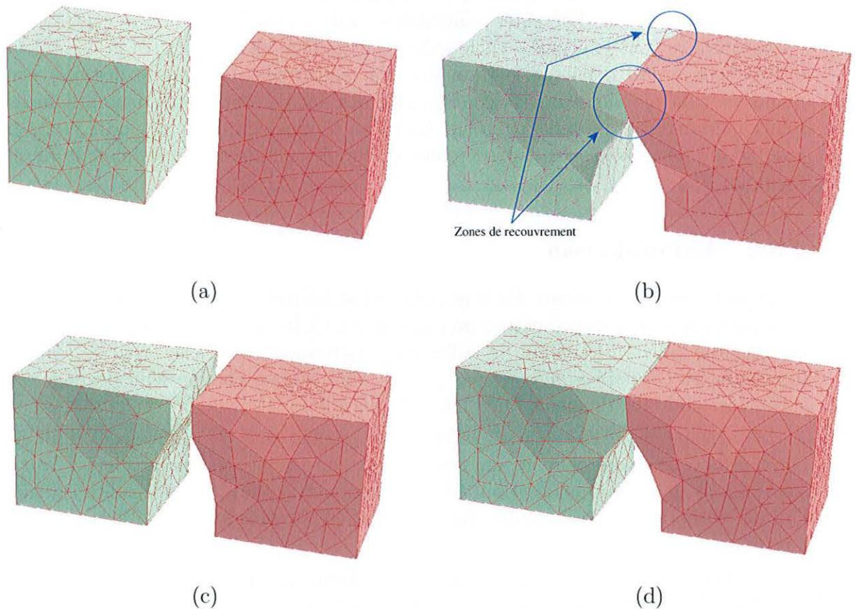
FIG. 4.17 : Le modèle synthétique dans l'espace paramétrique  $(u, v, t)$  après interpolation de  $u$  et de  $v$ . (a) Sans aucune contrainte liée aux rejets; (b) la contrainte de continuité  $C_0$  est ajoutée, noter le recouvrement entre les deux blocs; (c) avec la contrainte de continuité  $C_1$ , les tétraèdres de part et d'autre prennent la même orientation; (d) lorsqu'on augmente le poids de la contrainte de continuité, on obtient une correspondance parfaite.
