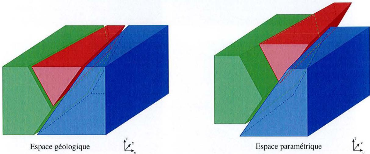
FIG. 4.21 : Glissement de blocs en extension autour de deux failles en Y. À gauche, modèle géologique actuel (les blocs ont été légèrement écartés pour faciliter la visualisation). À droite, dans l'espace paramétrique, les blocs sont situés dans leur position lors de leur formation. Les blocs ont ici glissé en trois dimensions, on ne peut donc pas se contenter d'observer les déplacements dans un plan de coupe vertical.
