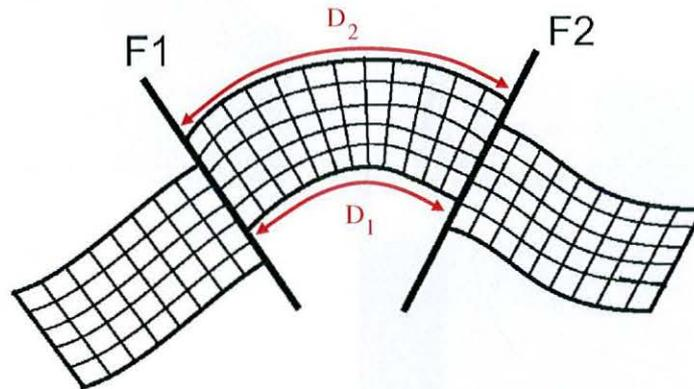
FIG. 1.11 : Vue en coupe d'une grille stratigraphique coupée par deux failles et induisant une erreur dans le calcul des distances. Les longueurs réelles  $d_1$  et  $d_2$  sont différentes, mais sont représentées dans la grille par le même nombre de cellules : elles sont donc considérées comme identiques si une modélisation de propriété est faite suivant cette grille.
