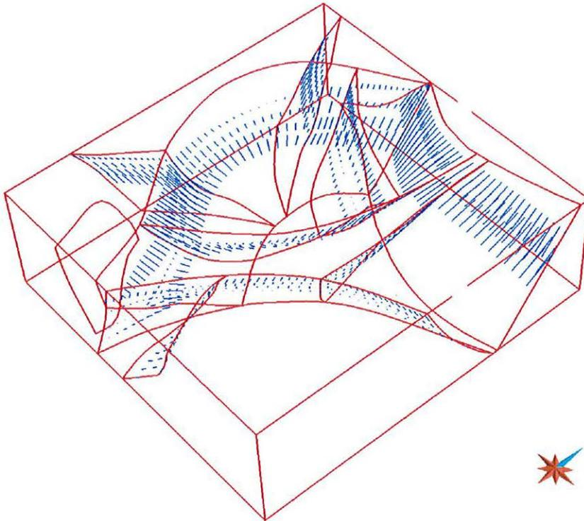
FIG. 4.9 : Ensemble de vecteurs rejet générés automatiquement à différentes valeurs de temps dans un volume tétraédrique. Le calcul par surface d'isovaleur de  $t$  génère des vecteurs rejet situés dans des plans particuliers et non pas répartis de manière homogène sur les surfaces de faille.
