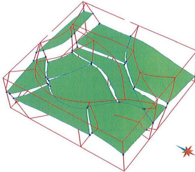
FIG. 4.7 : Surface d'isovaleur extraite depuis un volume tétraédrique et sur laquelle des extrémités de bordure (boules bleues) ont été installées automatiquement. Toutes les extrémités de bordure sont situées sur des arêtes du modèle (en rouge) et les extrémités situées sur la même arête sont associées.
