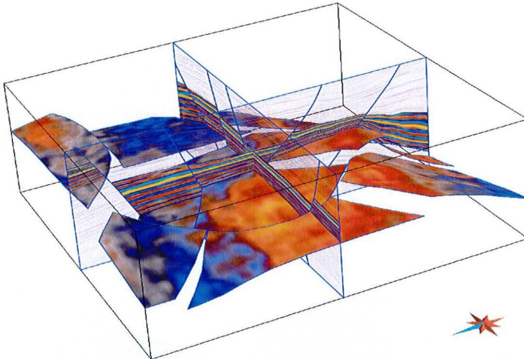
FIG. 5.18 : Visualisation de l'amplitude sismique correspondant à une couche géologique particulière. L'existence de la paramétrisation permet de définir une couche géologique dans l'espace  $\bar{G}$  entre deux surfaces d'isovaleur du paramètre  $t$ . Un masque de transparence est alors appliqué à tous les terrains en dehors de cette couche qui apparaît clairement dans l'espace géologique (d'après les travaux de T. Frank, [Frank, 2005]).
