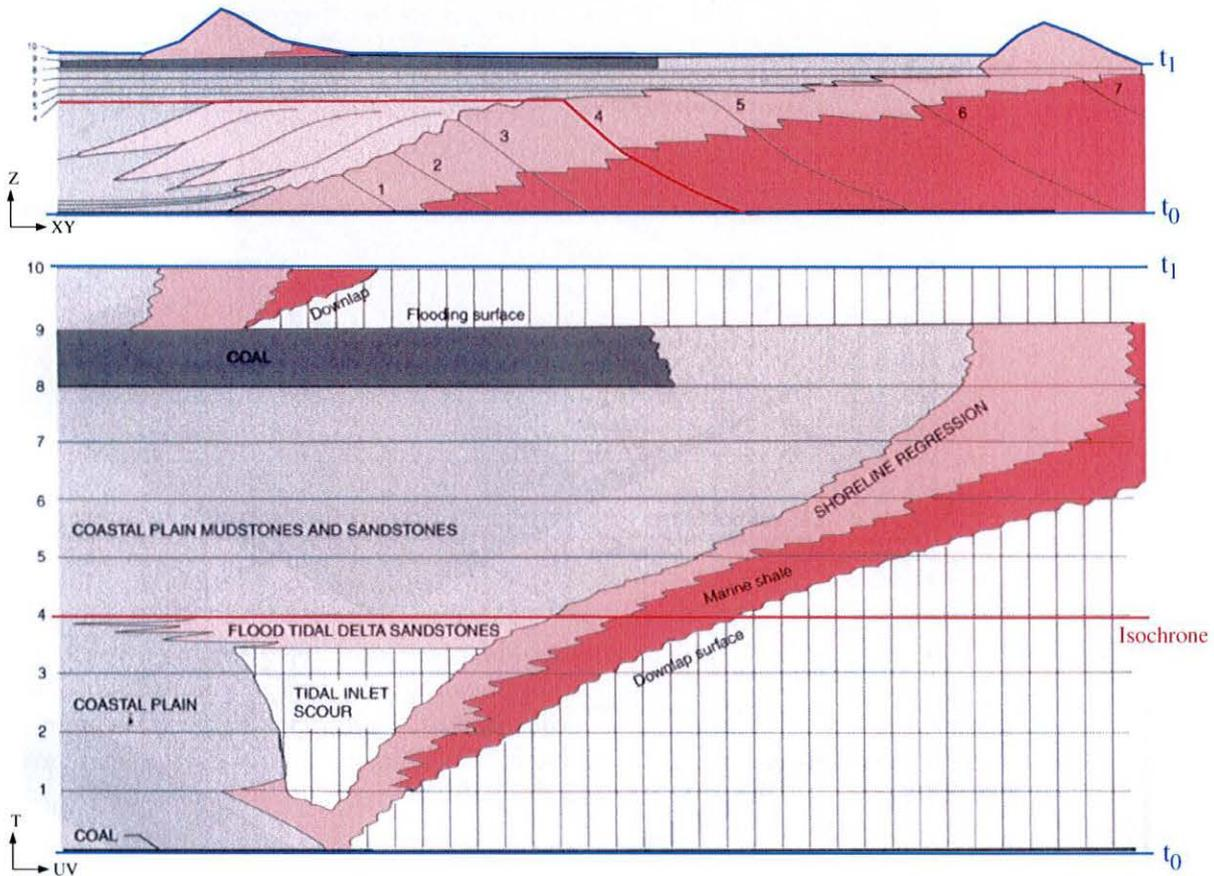
FIG. 5.6 : Correspondance entre l'espace géologique et l'espace de Wheeler. En haut, modèle lithostratigraphique de plaine côtière, en bas, le même modèle présenté dans l'espace chronostratigraphique de Wheeler (d'après [Emery et Myers, 1996]). Dans l'espace de Wheeler, les deux limites de séquences majeures (en bleu) sont horizontales de même que toute isochrone intermédiaire (en rouge). Noter l'importance des zones de non dépôt ou d'érosion au cœur des séquences.
