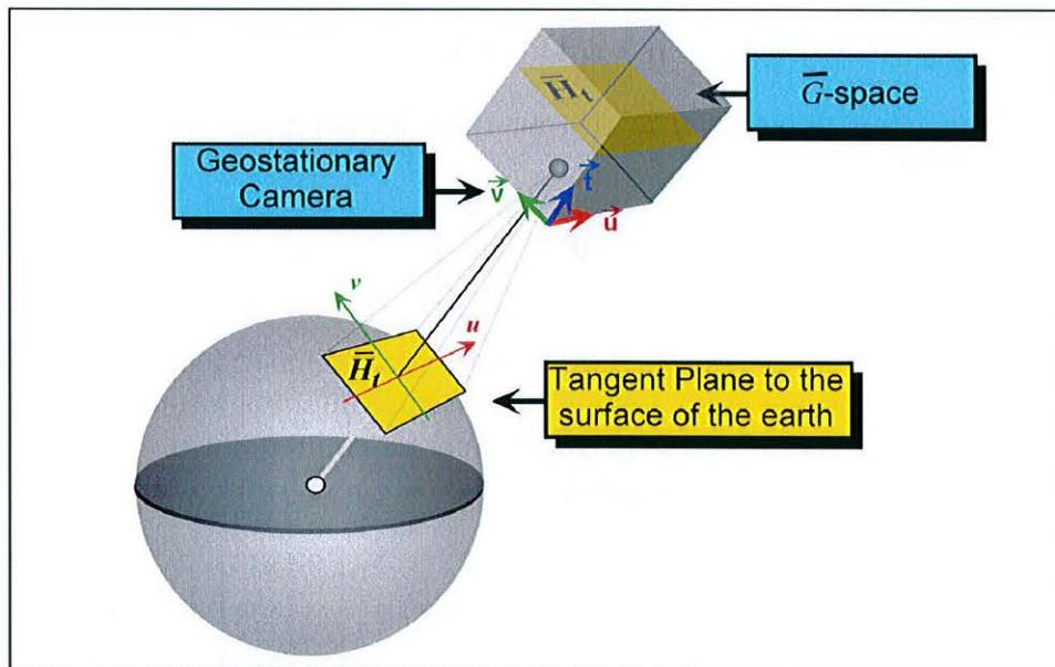
FIG. 2.3 : L'espace paramétrique  $\overline{G}$  vu comme un empilement continu d'images de l'espace de dépôt, prises depuis un satellite géostationnaire au-dessus de la zone étudiée, au cours du temps ([Mallet, 2004]).
