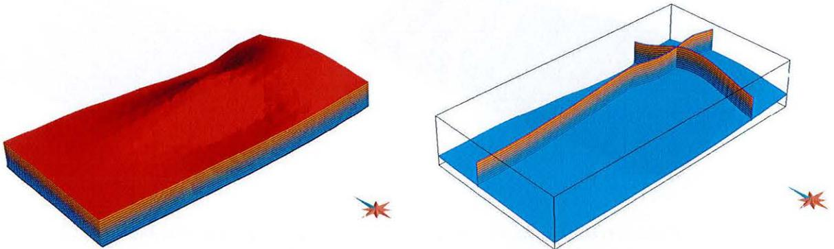
FIG. 3.15 : Calcul du paramètre  $t$  sur le modèle de Split Mountain, Utah (exagération verticale  $\times 2$ ). Un temps constant a été affecté à chacun des horizons de la figure 3.14. À gauche, le volume tétraédrique peint avec le temps, à droite, deux coupes verticales dans le modèle et une surface d'isovaleur de  $t$  mettant en évidence la courbure du modèle.
