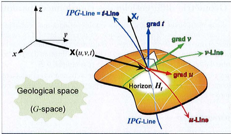
FIG. 2.6 : Repère paramétrique  $(x_u, x_v, x_t)$  de l'espace géologique. Les vecteurs  $x_u$  et  $x_v$  sont tangents à l'horizon  $H_t$  au point  $x$  et chacun des trois vecteurs est tangent à la ligne d'isovaleur correspondante ([Mallet, 2004]).
