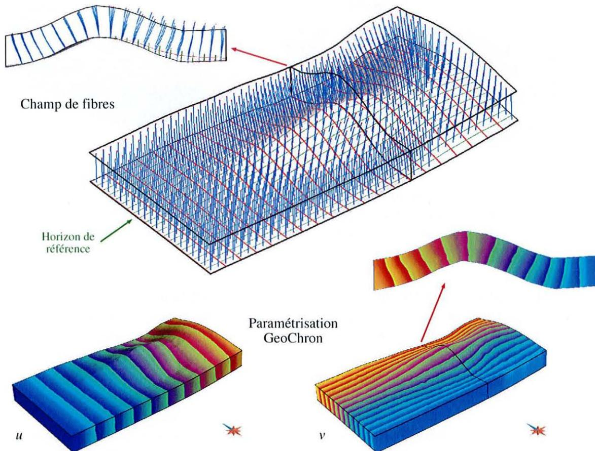
FIG. 3.19 : Paramétrisation du modèle de Split Mountain par la méthode des fibres (exagération verticale  $\times 2$ ). En haut, champ de fibres extraites depuis l'horizon de référence. La coupe montre la courbure des fibres au centre du pli. En bas, paramétrisation GeoChron correspondante (seuls  $(u, v)$  sont représentés,  $t$  étant calculé indépendamment de la méthode de construction). La coupe dans la paramétrisation indique un style en pure bending (voir figure 3.20).
