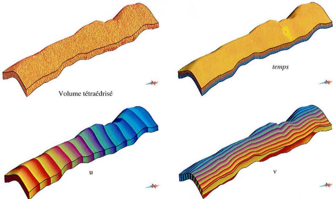
FIG. 5.11 : Modèle volumique tétraédrique (en haut à gauche, avec le maillage) avec une paramétrisation GeoChron (en haut à droite, composante  $t$ , en bas composantes  $u$  et  $v$  de la paramétrisation), exagération verticale  $\times 2$ .
