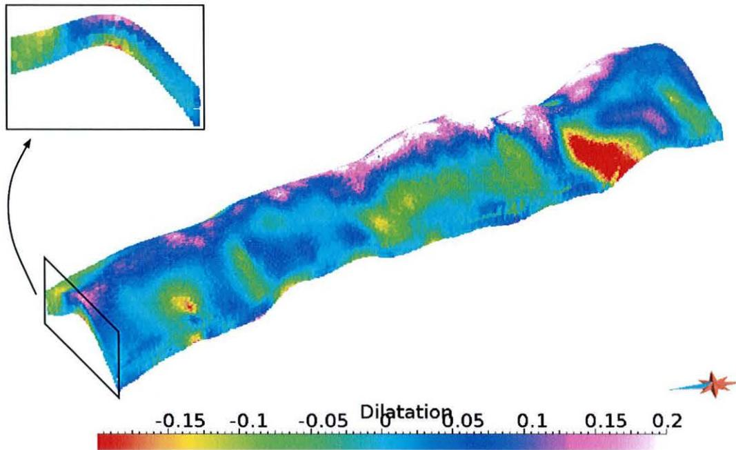
FIG. 5.12 : Dilatation  $\theta$  sur le modèle précédent, calculée à partir de la paramétrisation de la figure 5.11 (exagération verticale  $\times 2$ ). Les valeurs sont constantes sur chaque tétraèdre et sont représentées comme un point au centre de celui-ci. Le détail de la section de gauche met en évidence la dilatation plus élevée au sommet de la couche qu'à la base.
