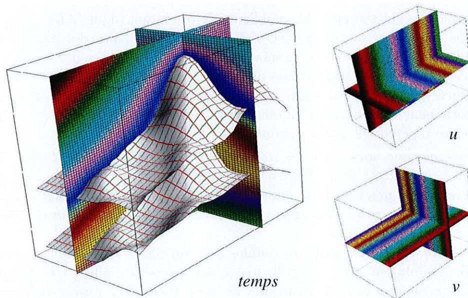
FIG. 3.4 : Paramétrisation GeoChron calculée sur une grille structurée régulière (« Voxet »). À gauche, les deux horizons initiaux, peints avec des lignes d'isovaleur de  $u$  et  $v$  ainsi que le paramètre  $t$  dans le volume ; à droite, les composantes  $u$  et  $v$  dans le volume. L'horizon du bas a été utilisé comme horizon de référence pour  $(u, v)$ .
