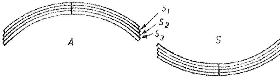
FIG. 2.12 : Déformation d'une couche par glissement banc sur banc (flexural slip), dans un anticlinal (A) et dans un synclinal voisin (S). Chaque sous-couche  $S_1, S_2, S_3 \dots$  garde sa longueur d'origine après déformation ([Hills, 1963], p. 222).
