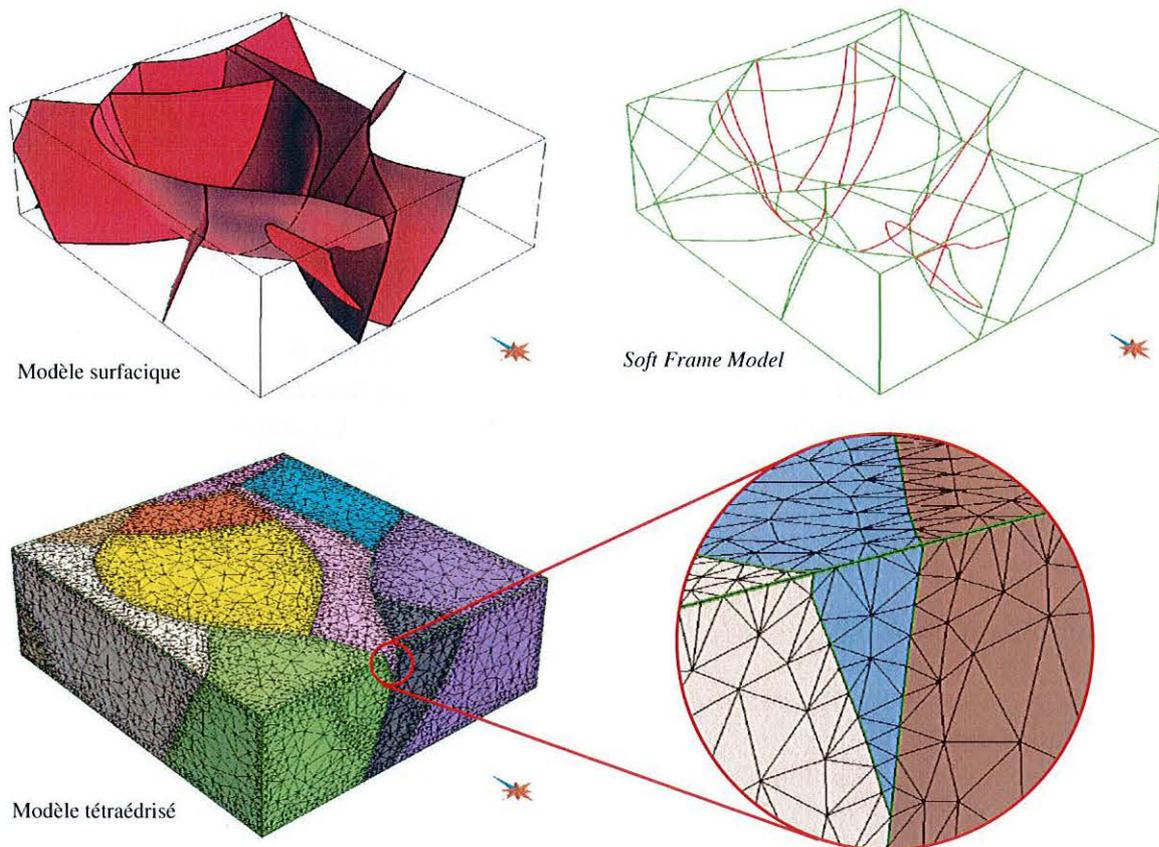
FIG. 1.6 : *Modèle surfacique (en haut à gauche) et modèle topologique (Soft Frame Model) correspondant (en haut à droite). Les lignes rouges figurent des arêtes radiales internes, c'est-à-dire des intersections entre failles. En bas, maillage tétraédrisé issu de ce modèle topologique. La loupe de droite met en évidence l'adéquation du maillage aux failles.*
