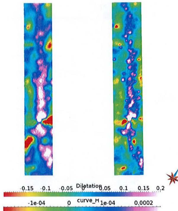
FIG. 5.13 : Comparaison de la dilatation  $\theta$  et de la courbure moyenne. À gauche, vue en carte de la dilatation sur le volume, à droite, vue en carte de la courbure gaussienne moyenne sur l'horizon supérieur du modèle. La similarité entre les deux images correspond bien au modèle théorique de déformation en pure bending.
