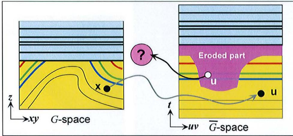
FIG. 2.4 : Coupe verticale illustrant la correspondance entre  $G$  et  $\overline{G}$ , en présence de zones d'érosion. Certains points de l'espace paramétrique n'ont pas de correspondance dans l'espace géologique initial ([Mallet, 2004]).
