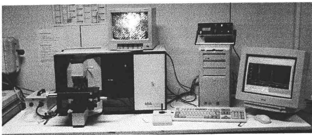
Figure 2 : Dispositif expérimental de la retro-diffusion ( \mu -Raman)
