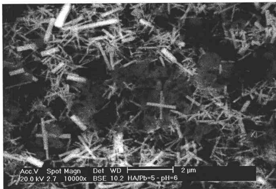
Figure 12 : Image au microscope électronique à balayage des produits de la réaction entre l'hydroxyapatite synthétique solide et le plomb, au rapport massique HA/Pb de 5/1, en mode BSE.
