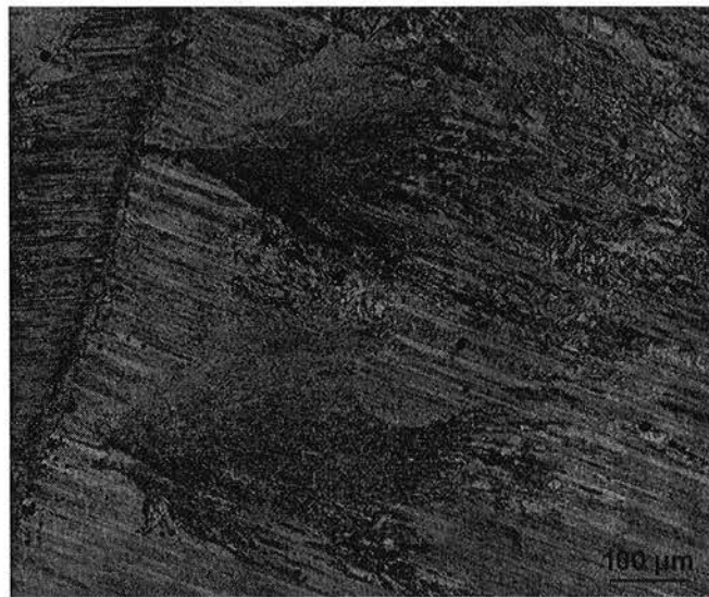
Figure I.14 : Vue micrographique de la structure en plumeaux obtenue dans un alliage Ti-48Al-2Cr-2Nb refroidi depuis 1385°C à 650°C/min.
