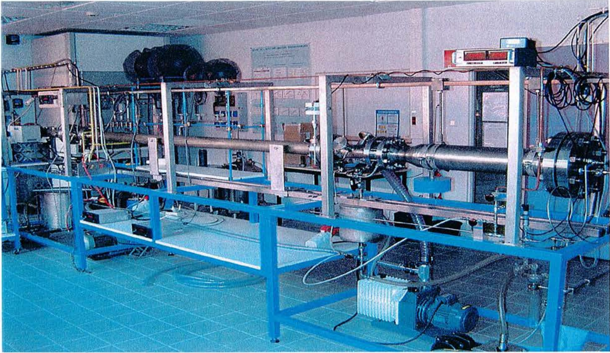
Figure B-5 : Photographie du tube à onde de choc et de son environnement proche.
