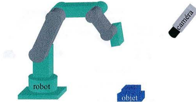
Fig. 4.2: Description de la configuration où la caméra est déportée
