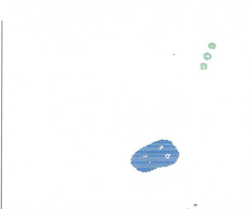
Fig. 3.6: Extraction des pixels du motif laser et des marqueurs lumineux par filtrage spatial et seuillage binaire
