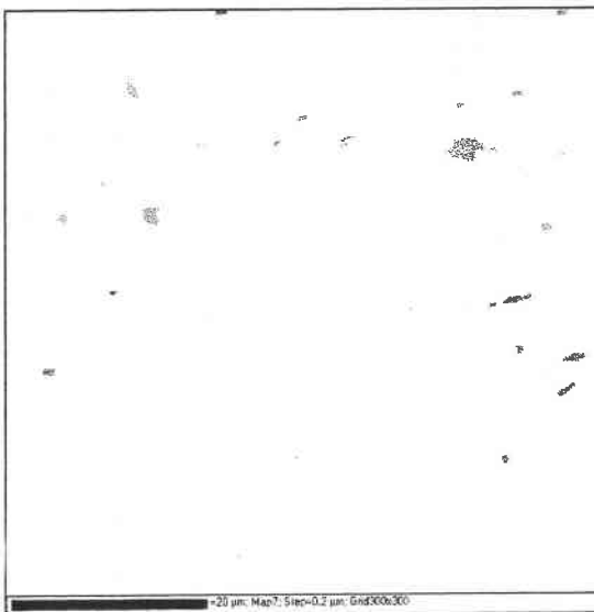
Fig. 5.2 : Cartographie de la phase austénitique
