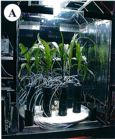
Photo 3 : Marquage de 9 plants de maïs dont la tige est brûlée pendant 0, 6, et 9 minutes. A gauche, les plants dans l'enceinte de marquage. A droite, les pièges à soude permettant de mesurer la respiration rhizosphérique.
