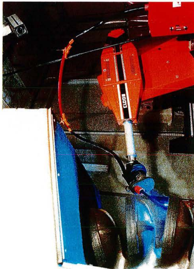
Figure 1.6 : Opération robotisée de ressuage pour la maintenance des augets d'une centrale hydraulique
