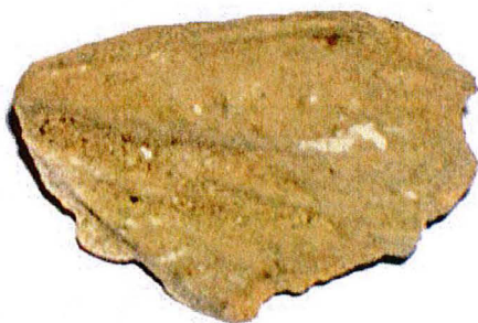
Figure IV - 4 : Échantillon de décolmatage issu de la pelle de la trémie 2.
