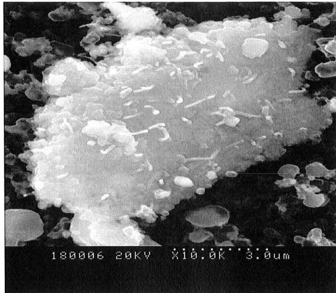
Figure III - 17 : Photo MEB en électrons secondaires d'un agrégat de particule provenant d'un filtre cheminée. La tension d'accélération est 20 KV.
