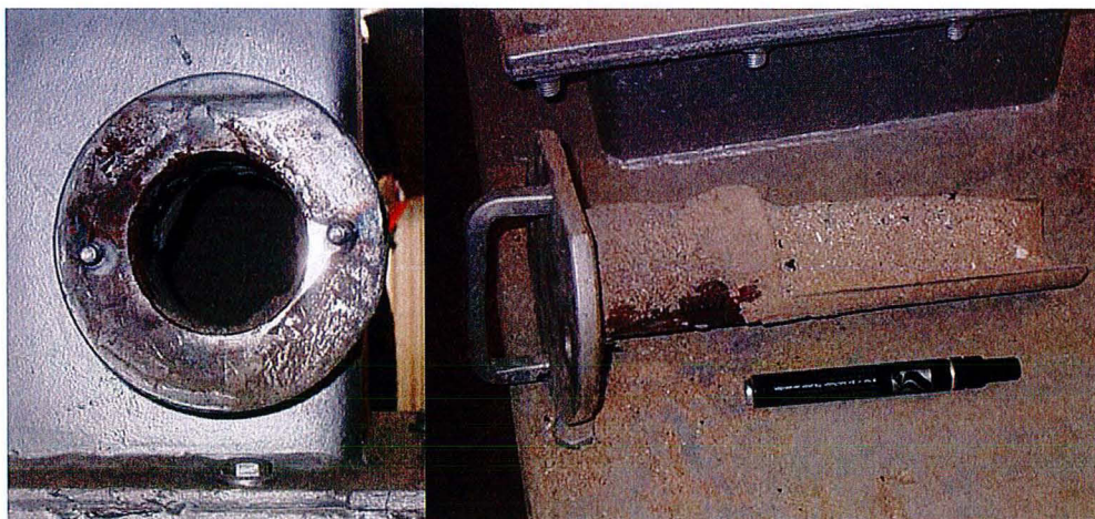
Figure III - 2 : Prise d'échantillon au niveau d'une trémie de cendres volantes de l'UVE. L'échantillon présent dans la pelle représente environ 200 g de cendres volantes.
