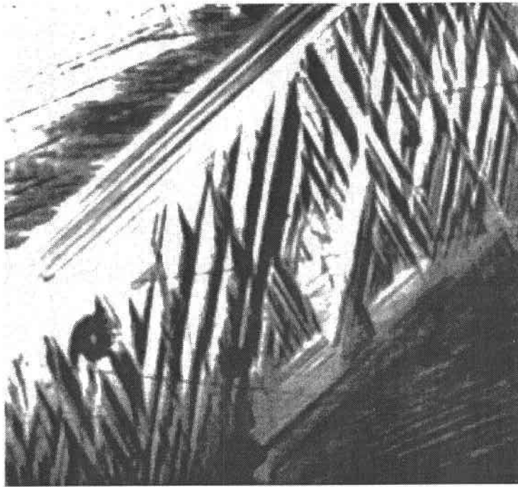
Fig. III.16 : Apparition d'un groupe auto-accommodant lors de la transformation d'un alliage à base cuivre.
