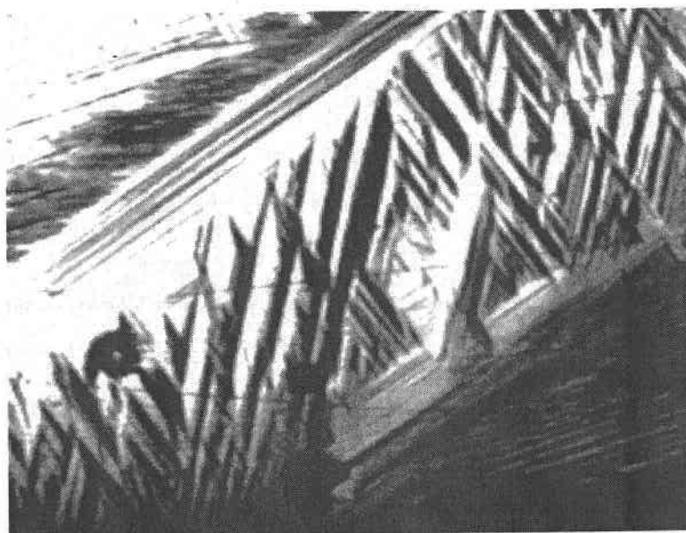
Fig. IV.4 : Apparition de groupes autoaccommodants dans un AMF à base cuivre. Ces variantes ne donnent aucune déformation macroscopique mis à part un léger cisaillement (voir tableau III.3).
