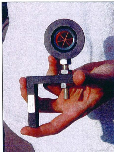
Figure 4-3 : Prisme réflecteur GMP 105 Leica. Les prismes sont constitués d'un coin de cube en verre monté sur un support en aluminium (module de Young de l'aluminium :  $E \approx 70 \text{ GPa}$ , coefficient de dilatation thermique :  $\alpha \approx 2,4 \cdot 10^{-5} \cdot \text{K}^{-1}$ ).
