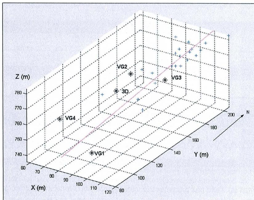
Figure 4-26 : Les 21 foyers d'événements de type « Méca 1 » localisés par CHEAP, d'après Clément (2004). Ces foyers s'organisent selon un plan qui semble correspondre à une fracture  $\text{N}20^\circ\text{E}$  observable sur le terrain. L'axe des cotes représente les altitudes. Les positions des différentes sondes sont reportées sur la figure.
