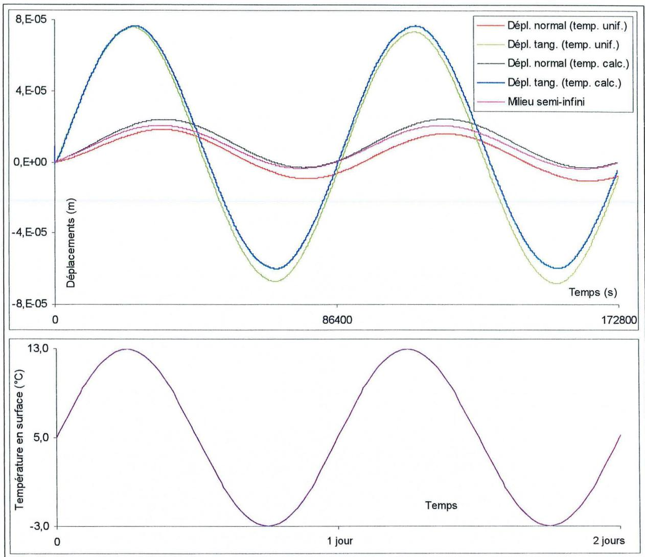
Figure 3-20 : Déplacements normaux et tangentiels du point T.
