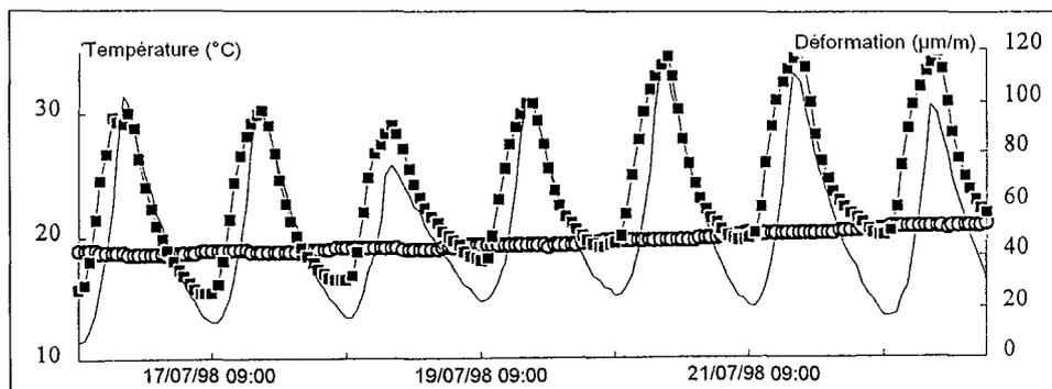
Figure 3-5 : Corrélation entre température de surface et déformations en profondeur dans un petit massif calcaire. Mesures pendant 7 jours consécutifs des déformations (en  $\mu\text{m/m}$ , carrés pleins) et de la température (ronds évidés) à une profondeur de 82 cm dans un massif calcaire comparées à la température de l'air extérieur (trait continu). D'après Bertolus (1998).
