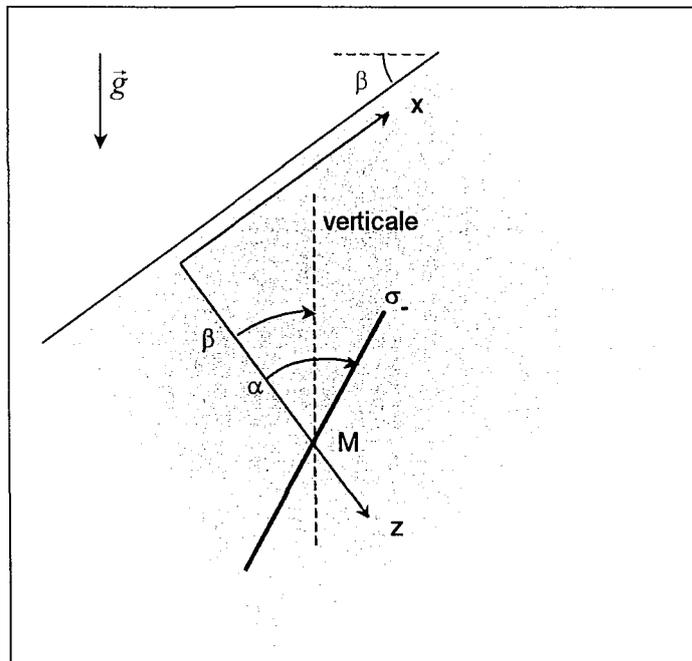
Figure A6-3 : Orientation de la direction principale correspondant à  $\sigma_-$  (contrainte mineure dans le plan  $xz$ ) en M.
