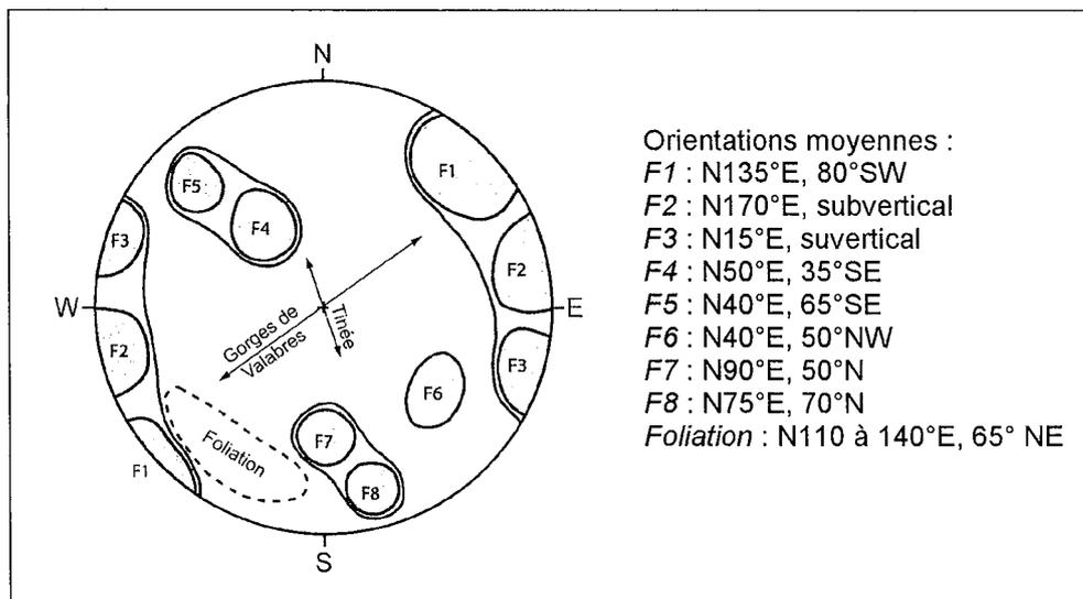
Figure 2-11 : Orientation des discontinuités d'échelle déci- à décamétrique.
