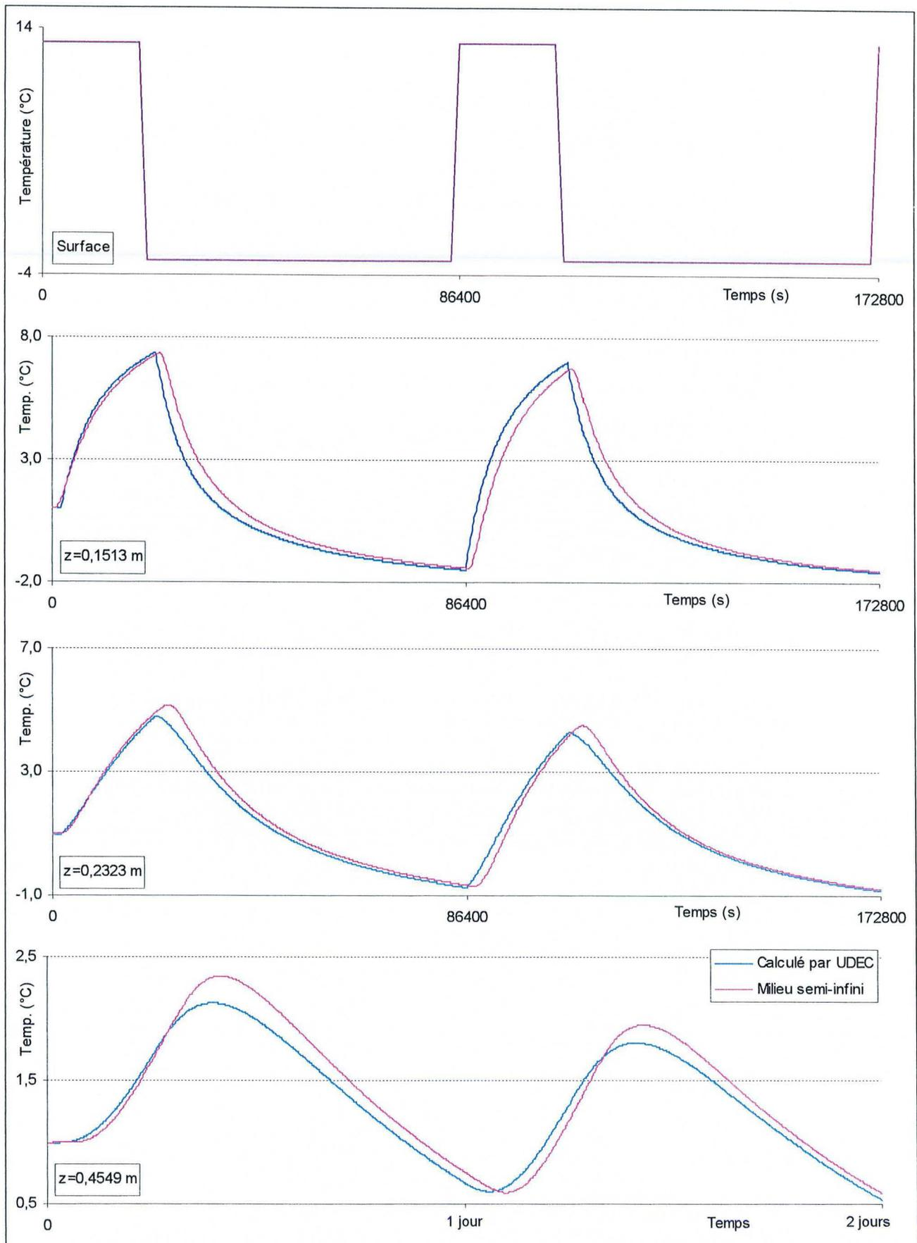
Figure 3-22 : Evolution dans le temps des températures à différentes profondeurs  $z$ .
