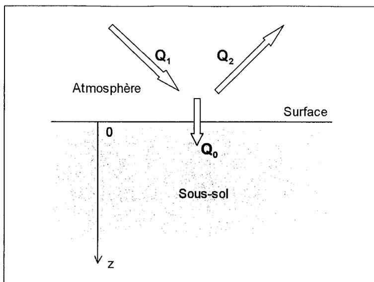
Figure A5-1 : Flux de chaleur échangés entre le sous-sol et l'atmosphère à travers la surface du sol.
