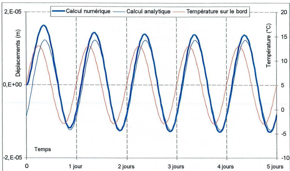
Figure 3-10 : Déplacement normal du point M d'après les calculs numériques et analytiques lors du calcul thermoélastique.
