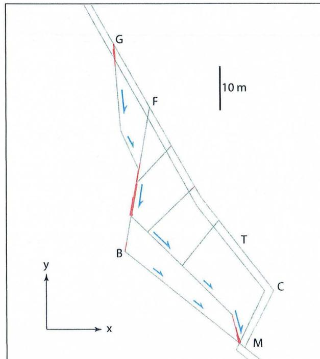
Figure 3-27 : Déplacements normaux et tangentiels le long des fractures de la « zone menaçante » à  $t=12$  heures. L'épaisseur des surcharges est proportionnelle à l'ouverture (ouverture maximale :  $6 \cdot 10^{-6}$  m). La longueur des demi-flèches est proportionnelle au déplacement cisailant (cisaillement maximal :  $1,2 \cdot 10^{-5}$  m).
