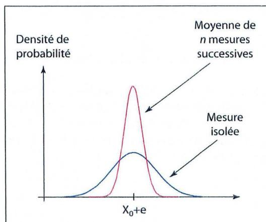
Figure A7-11 : Lois de probabilité correspondant à une mesure isolée et à la moyenne  $m$  de  $n$  mesures successives réalisées dans des conditions identiques. Les deux lois sont centrées sur la valeur  $X_0+e$ .
