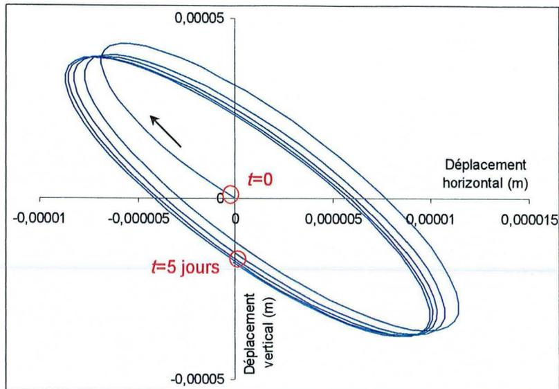
Figure 3-8 : Trajectoire du point F au cours du calcul thermoélastique
