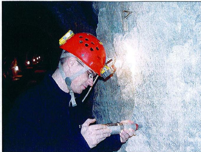
Figure 2-14 : Utilisation du scléromètre dans une galerie EDF.
