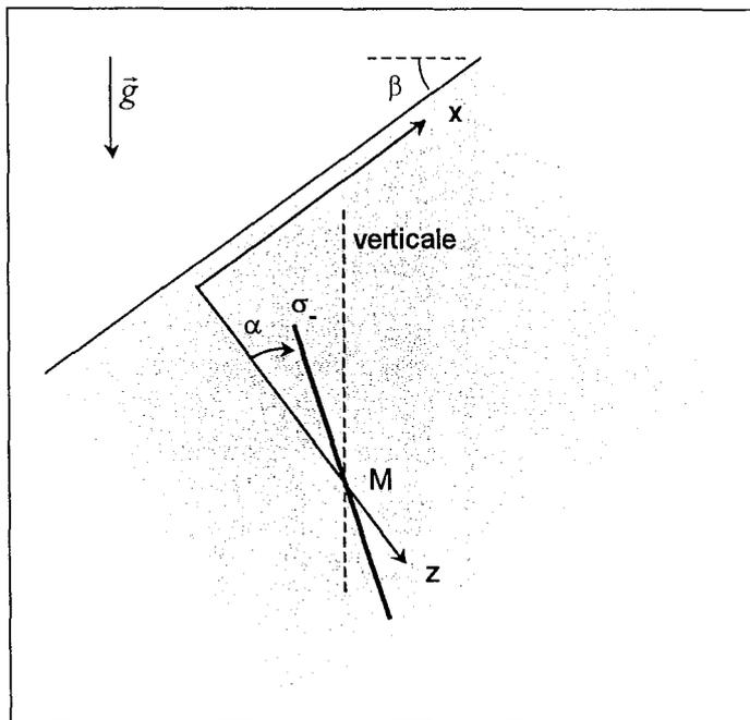
Figure A6-5 : Orientation de la direction principale correspondant à  $\sigma_-$  (contrainte mineure dans le plan  $xz$ ) en M.
