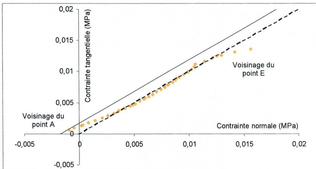
Figure 3-7 : Etats de contraintes en quelques points de AE à la fin de la consolidation élastique.
