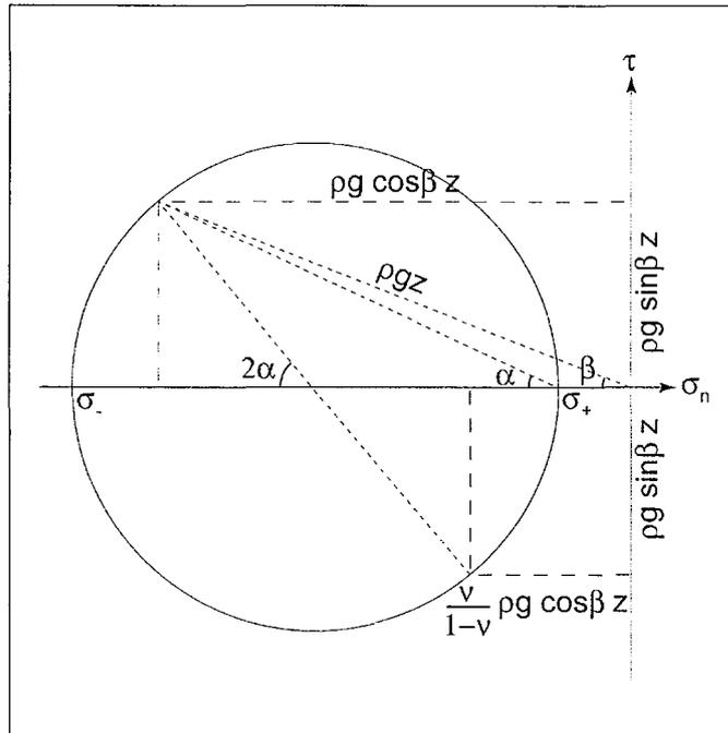
Figure A6-2 : Représentation de Mohr des états de contraintes dans le plan  $xz$ .
