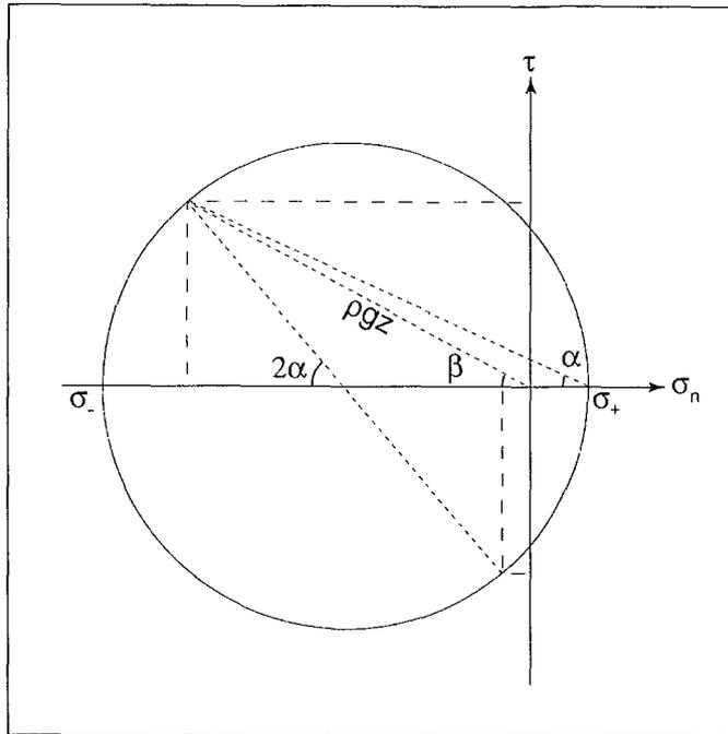
Figure A6-4 : Représentation de Mohr des états de contraintes dans le plan  $xz$ .
