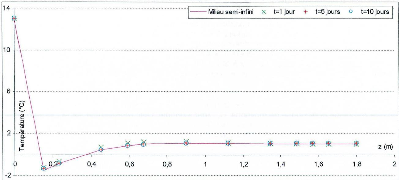
Figure 3-23 : Profils de températures au droit du point T à différents instants. Les résultats des calculs numériques pour  $t=1$ ,  $t=5$  et  $t=10$  jours sont comparés au profil déterminé analytiquement avec le modèle du milieu semi-infini en régime périodique pour  $t=k$  jours.
