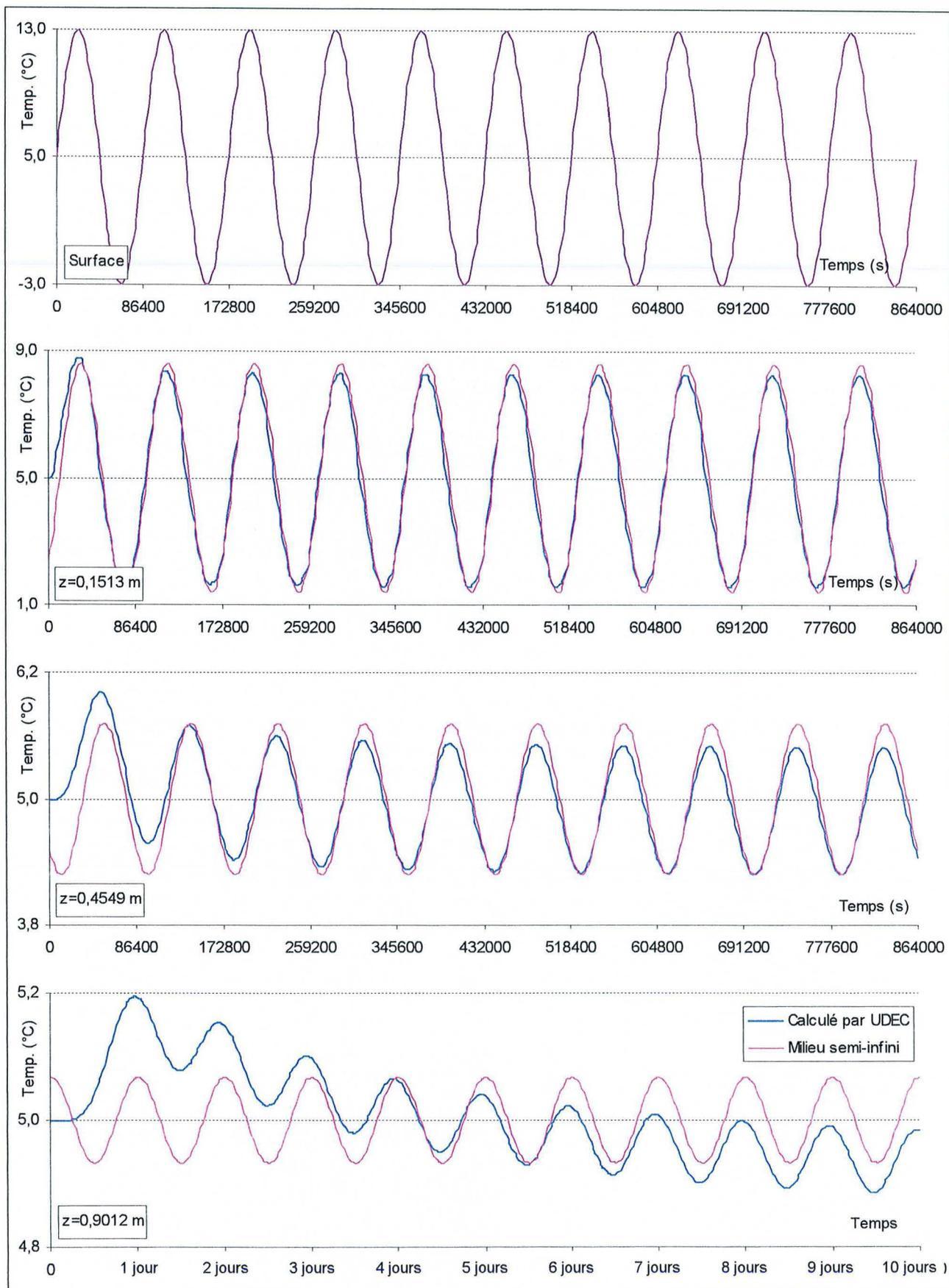
Figure 3-18 : Evolution dans le temps des températures à différentes profondeurs  $z$ .
