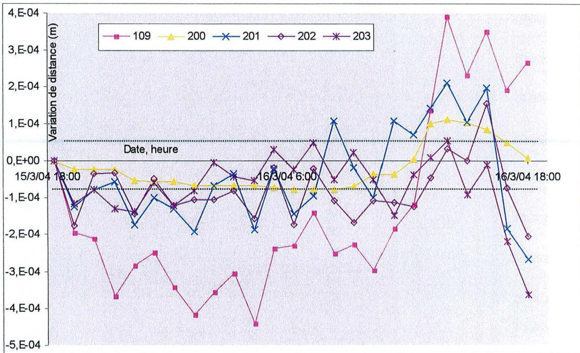
Figure 4-19 : Variations de  $D_p$  pour les prismes 109, 200, 201, 202 et 203 au cours de la campagne d'hiver après correction par des coefficients  $\alpha$  calculés *a posteriori*.
