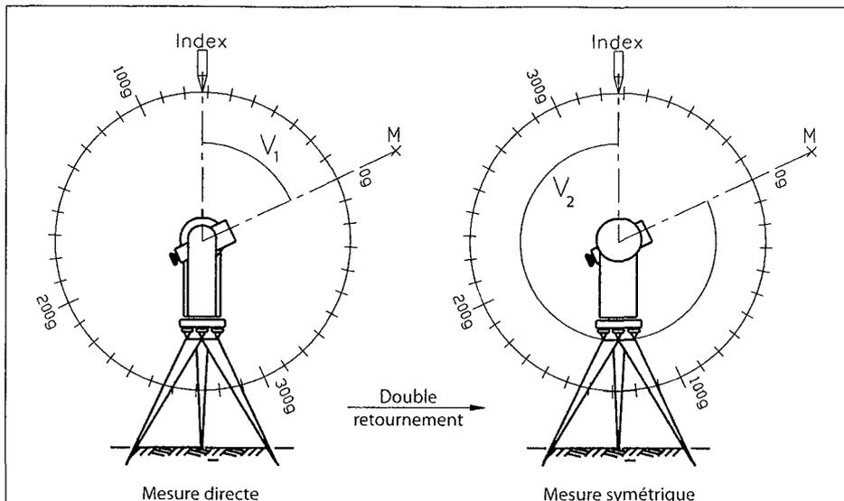
Figure A7-9 : Utilisation du double retournement pour la mesure de l'angle vertical  $V$  du point  $M$ .
