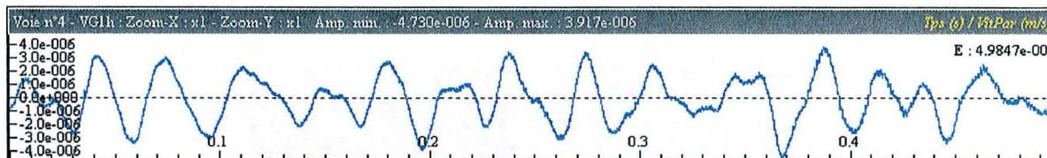
Figure 4-23 : Signal correspondant à un séisme enregistré le 6 octobre 2003 par G1. L'axe des abscisses représente le temps (s), l'axe des ordonnées la vitesse ( $\text{m}\cdot\text{s}^{-1}$ ).
