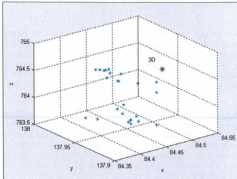
Figure 4-27 : Localisation de quelques foyers d'évènements de type « Méca 2 », d'après Clément (2004). L'axe des cotes représente les altitudes. La position de la sonde accélérométrique 3D est reportée sur la figure.
