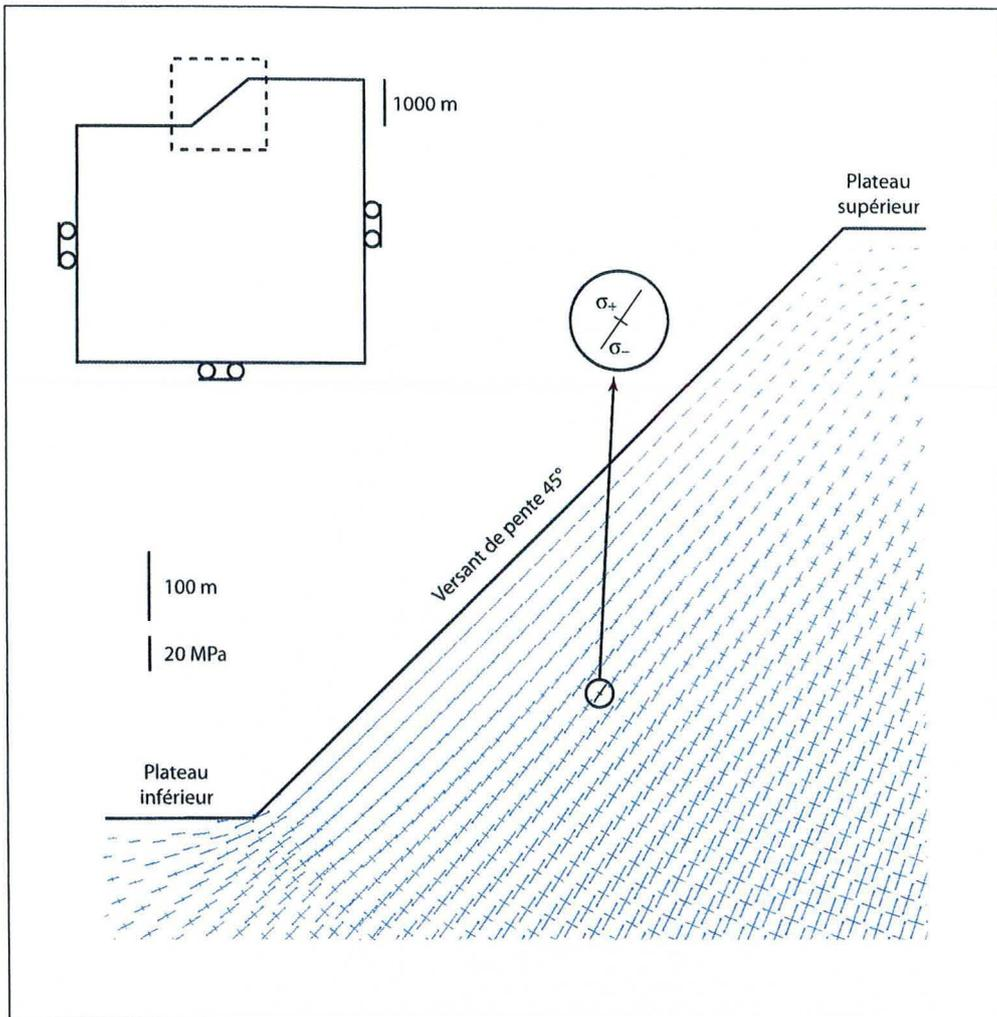
Figure A6-7 : Orientations et magnitudes des contraintes principales calculées à l'équilibre élastique avec CESAR. Les contraintes figurées sont toutes compressives. Rappelons que, dans le cadre de l'hypothèse des déformations planes, la contrainte principale perpendiculaire au plan de la figure peut être calculée à partir des deux contraintes principales de ce plan :  $\sigma_{yy} = \nu(\sigma_+ + \sigma_-)$ .
