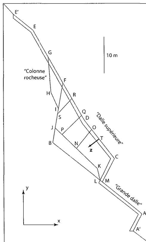
Figure 3-17 : Détail du modèle F montrant la géométrie des blocs de la « zone menaçante ». Noter la frange de raffinement du maillage au niveau de la surface et l'axe  $z$  selon lequel les profils de température sont analysés, de la surface (point T) vers la profondeur.
