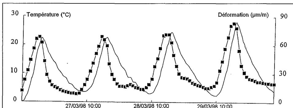
Figure 3-1 : Mesures *in situ* des déformations d'origine thermique dans un petit massif calcaire. Déformations à une profondeur de 82 cm (courbes avec carrés noirs) et température de l'air extérieur (trait continu). D'après Bertolus (1998).
