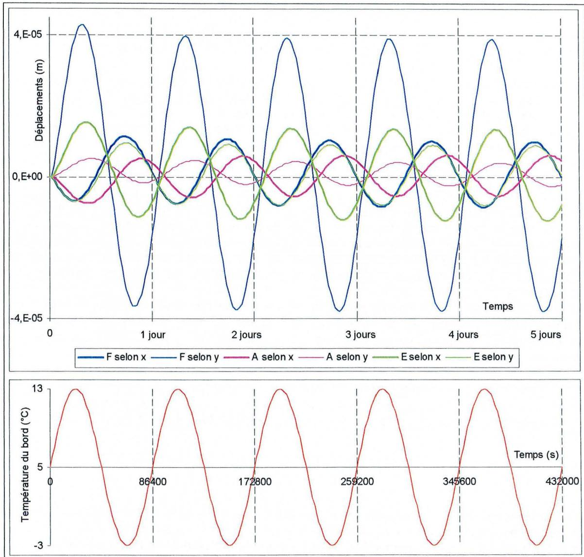
Figure 3-9 : Déplacement des points A,E et F au cours du calcul thermoélastique.
