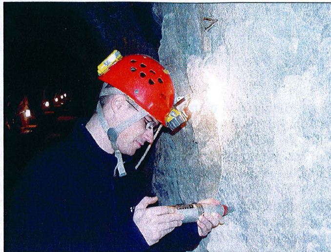
Figure 2-14 : Utilisation du scléromètre dans une galerie EDF.
