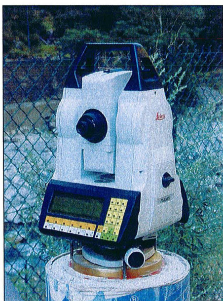
Figure 4-2 : La station totale TDA 5005 positionnée sur son support.
