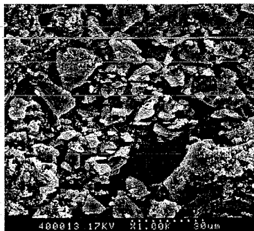
Figure III.5 : Photographie de microscopie électronique à balayage d'une poudre de lactose conservée 3 mois à 20°C sous une activité de l'eau de 0,76.
