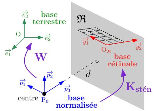
FIG. 3.2: Paramètres d'un sténopé
