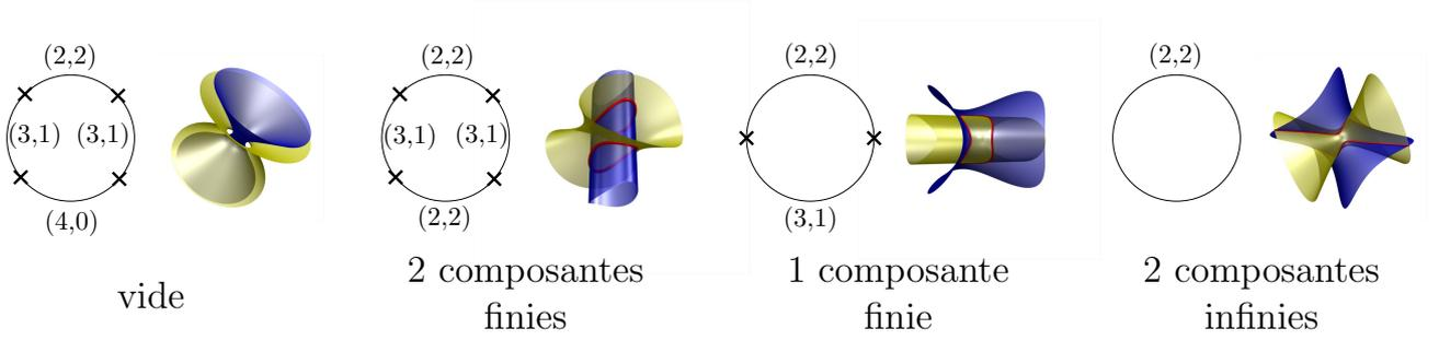
FIG. 5.1: Intersection de deux quadriques en position générique.
