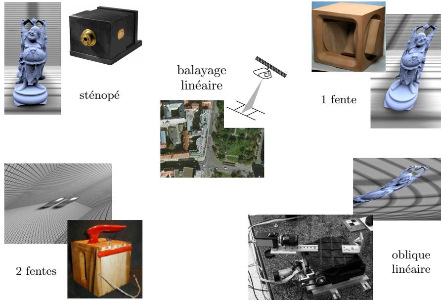
FIG. 3.1: Exemples d'appareils photo linéaires et d'images formées
