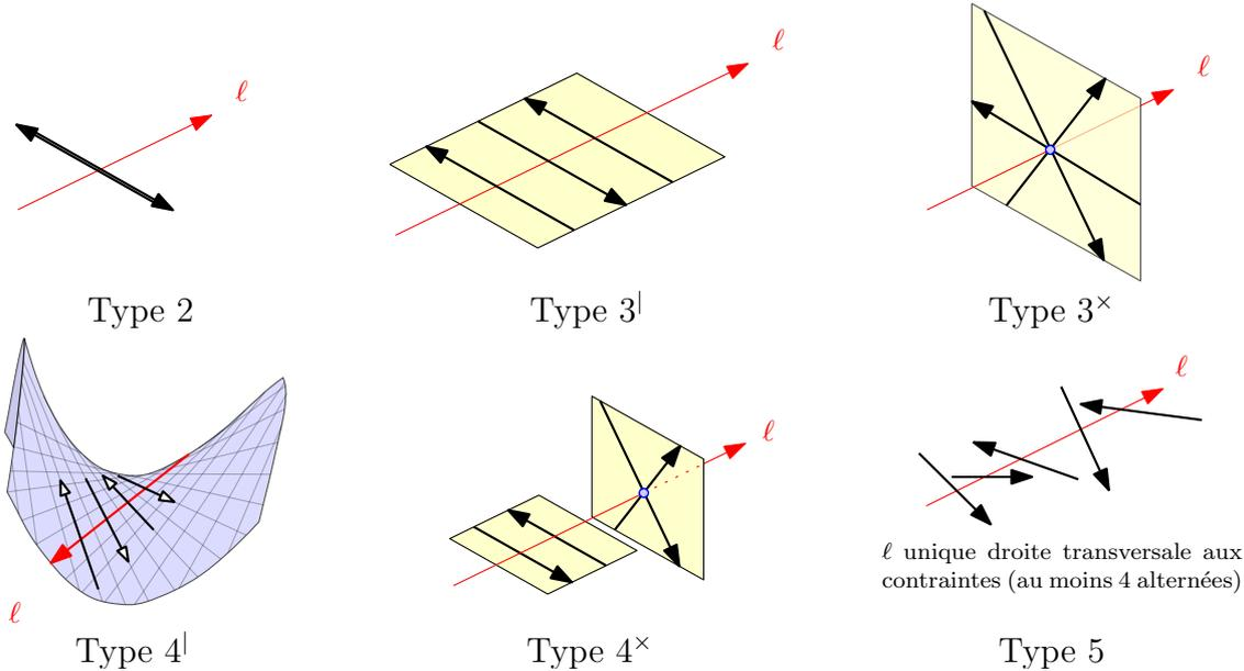
FIG. 4.5: Classification des blocs représentés par leurs contraintes.
