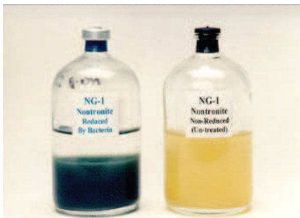
Figure I.7 : Illustration du changement de couleur de jaune à bleu-vert par réduction, dans une smectite riche en fer (échantillon de nontronite NG-1 (Hohen Hagen, Allemagne) en provenance de la collection de référence des argiles de la Clay Minerals Society ) (Stucki, 2011).
