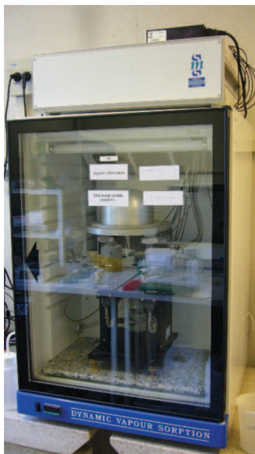
Figure II.7 : Instrument DVS (Surface Measurement Systems Ltd., London, UK) pour l'analyse de la sorption et désorption d'eau par les GSH
