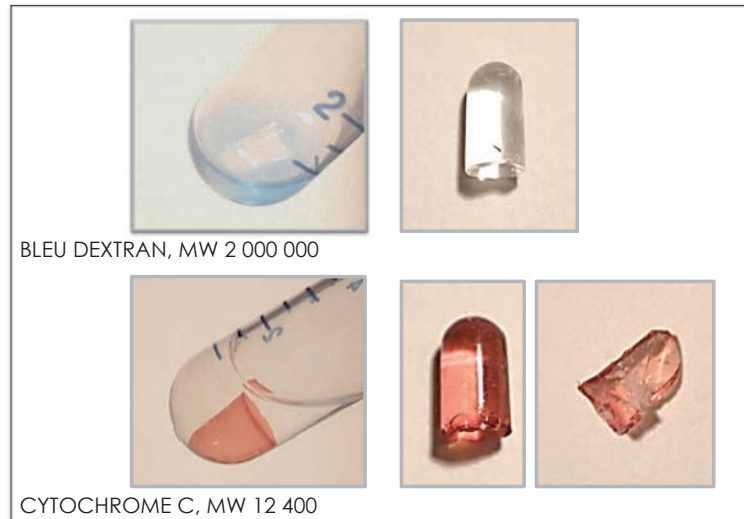
Figure III.11 : GSH à 100% TEOS après 1 semaine d'équilibre dans une solution contenant soit du Bleu Dextran (MW 2 000 000) soit du cytochrome C (MW 12 400).
