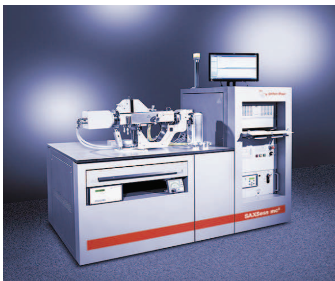
Figure II.5 : Instrument SAXSess mc 2 (Anton Paar) pour l'analyse de la structure des GSH par SAXS
