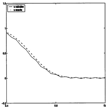
FIG. 1.9 - Schéma de Keller (1.5),  $\mu = 1/8$ ,  $T = 2.10^{-2}$ . Zoom sur  $[0.4, 0.8]$ .
