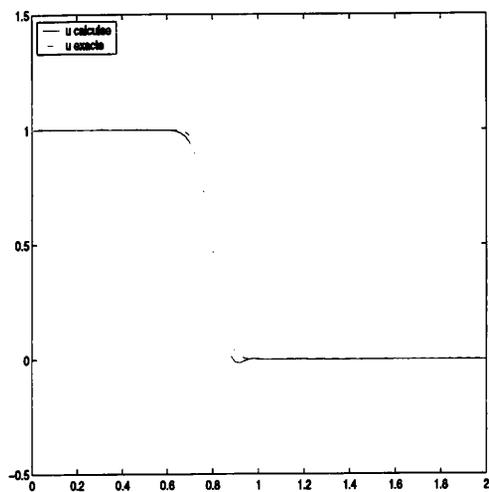
FIG. 4.3 - Test 1 : Décentrement  $D_p = 0.28$  donné par (4.27)
