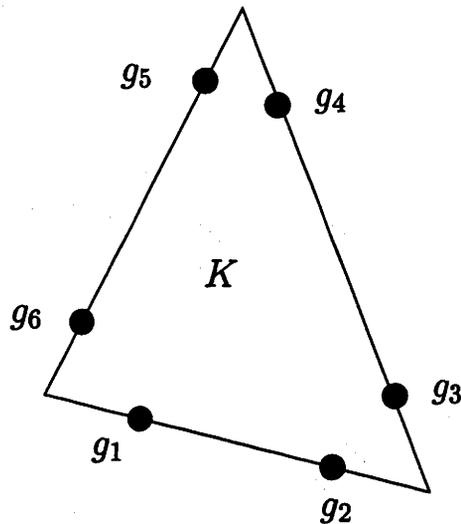
FIG. 2.7 – Points de Gauss d'un triangle  $K$
