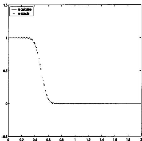
FIG. 1.8 - Schéma de Keller (1.5),  $\mu = 1/8$ ,  $T = 2.10^{-2}$ .
