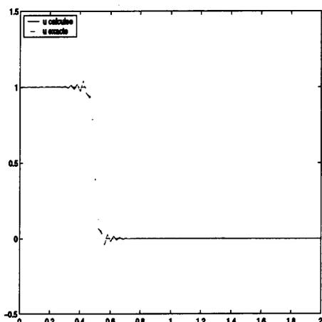
FIG. 1.6 - Schéma de Keller (1.5),  $\mu = 1/8$ ,  $T = 2.10^{-3}$ .
