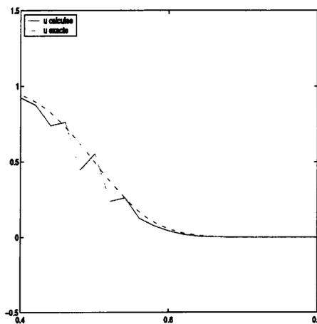
FIG. 1.3 - Schéma de Keller (1.5),  $\mu = 1$ ,  $T = 2.10^{-3}$ . Zoom sur  $[0.4, 0.8]$ .
