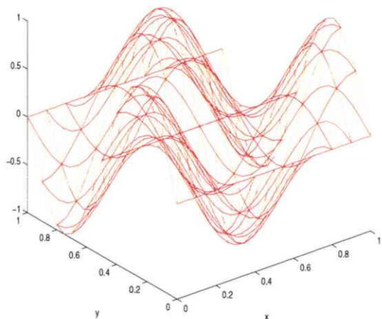
FIG. 2.13 – Test 1 : Solution  $u_h \in P_{nc,0}^2$  calculée par le schéma boîte  $P_{nc,0}^2 \times (RT^1 + \Phi)$ .
