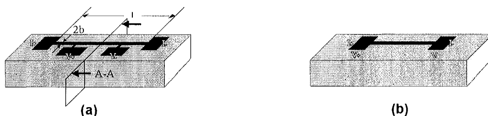
Figure II. 2 : Géométrie de l'échantillon pour la méthode 3\omega a) à quatre contacts et b) à deux contacts. Une bande métallique, ici en noir, sert à la fois d'élément chauffant et de thermomètre. Les contacts sont les connexions pour les amenées de courant ( I_+ , I_- ) et pour les prises de potentiel ( V_+ , V_- ). l est la distance entre les amenées de courant, 2b est la largeur de la bande chauffante et A-A est la vue de coupe de l'échantillon.
